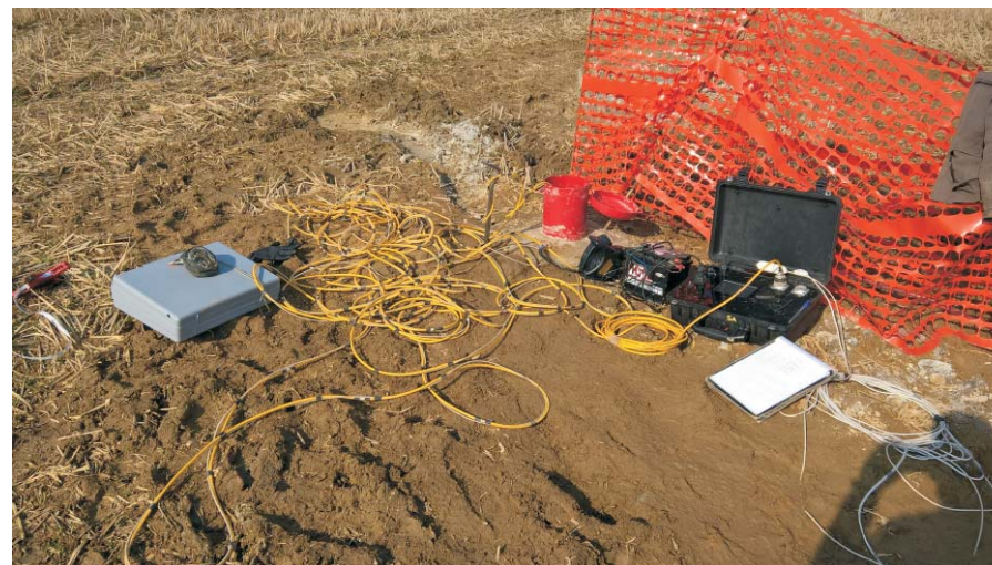
Foto n.2: Cross Hole 1 - sistema di ricezione, unità di acquisizione e compressori per il sistema di ancoraggio pneumatico del geofono triassiale
