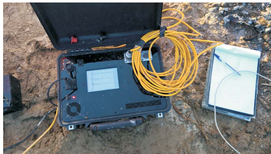
Foto n.6: Cross Hole 2, particolare dell'unità di acquisizione
