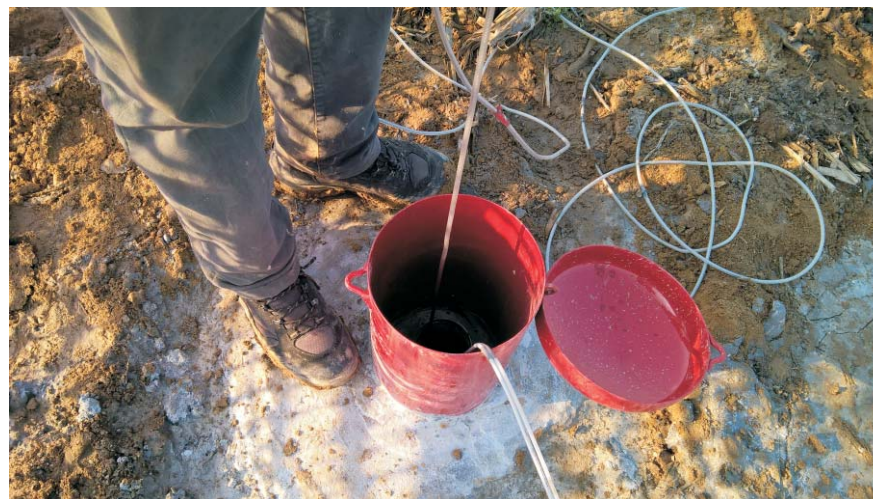
Foto n.5: Cross Hole 2 - energizzazione in foro
