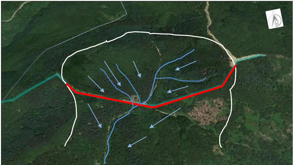
Figura 6 – Vista prospettica 3D dell'assetto idrografico dell'area di studio con evidenziata la direzione principale di deflusso delle acque superficiali (freccie azzurre)
