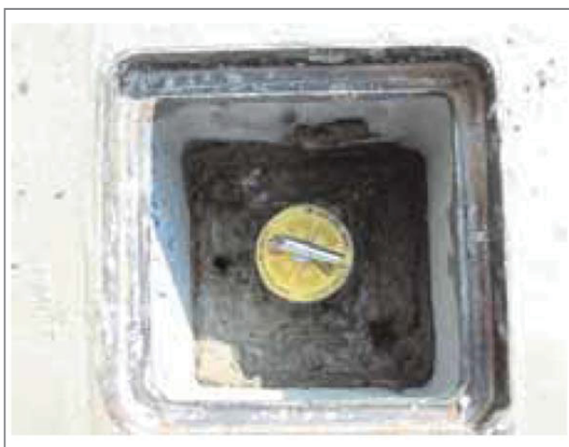
Fig. 12 – Schema pozzetto protezione piezometro
