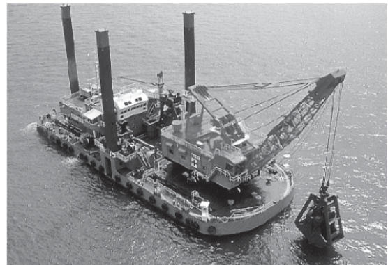
Figura 3-1 Moto-nave pontone: A sx escavatore idraulico a braccio rovescio; A dx escavatore tralicciato a funi
