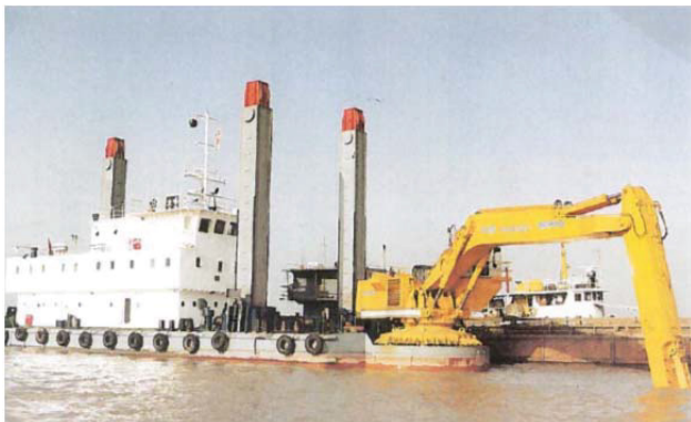
Figura 3-1 Moto-nave pontone: A sx escavatore idraulico a braccio rovescio; A dx escavatore tralicciato a funi
