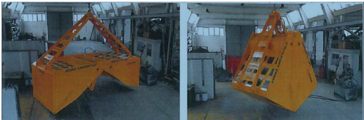
Figura 3-2 Benna ecologica: A sx in posizione di apertura; A dx in posizione di chiusura
