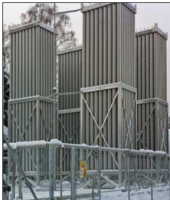
Figura 24: Vaporizzatori AAV
