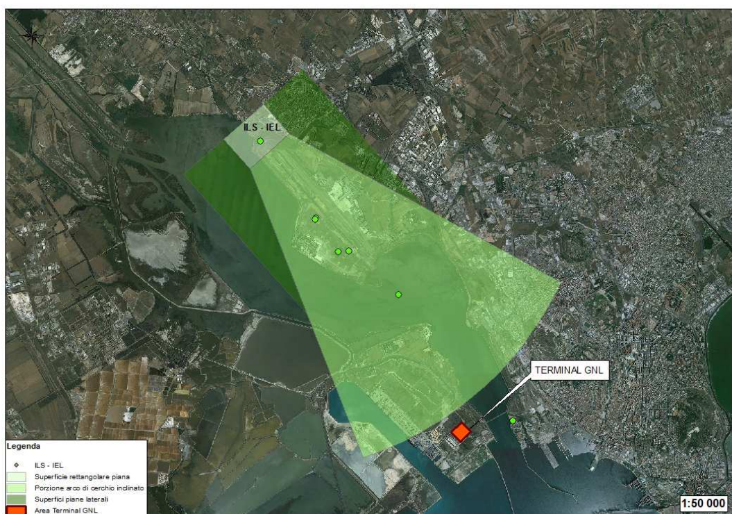
Figura 26 - BRA relative all'apparato direzionale ILS-IEL ( instrument landing system ovvero sistema strumentale di atterraggio )
