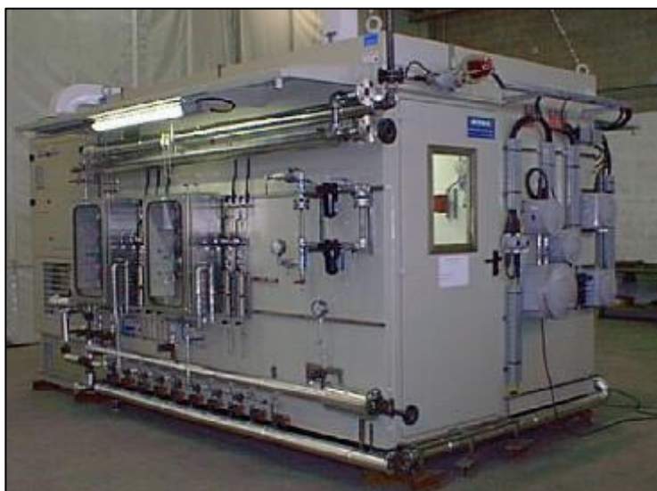
Figura 27: Skid Sistema di analisi – Cabina cromatografi
