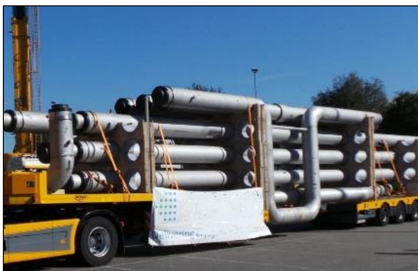
Figura 14: Loops di espansione per le tubazioni VIP
