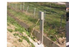
sensori passivi di rilevazione temperatura e stato del suolo
