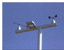
sensore per la rilevazione della velocità del vento
