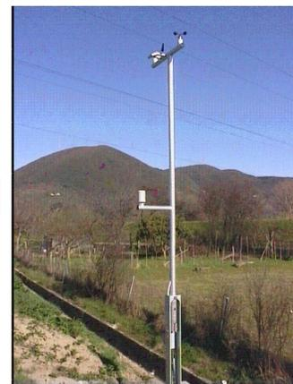
Postazione rilevamento meteo ambientale su palo basculante in acciaio zincato a caldo, con altezza minima 5 metri e con guancia di bilanciamento
