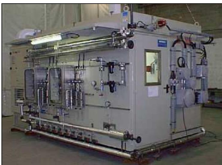
Figura 23 - Skid Sistema di analisi – Cabina cromatografi
