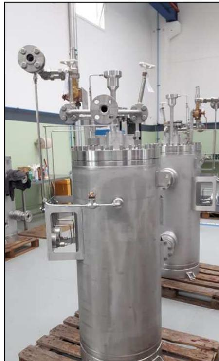
Figura 15: Particolare assemblamento criostato
