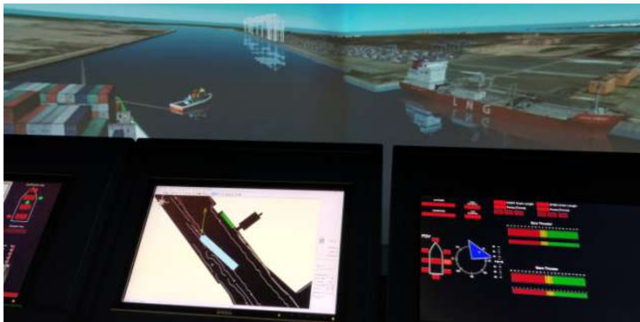
Figura 1-3 Simulatore SAND – Passaggio della nave portacontainer in ingresso presso l'accosto LNG
