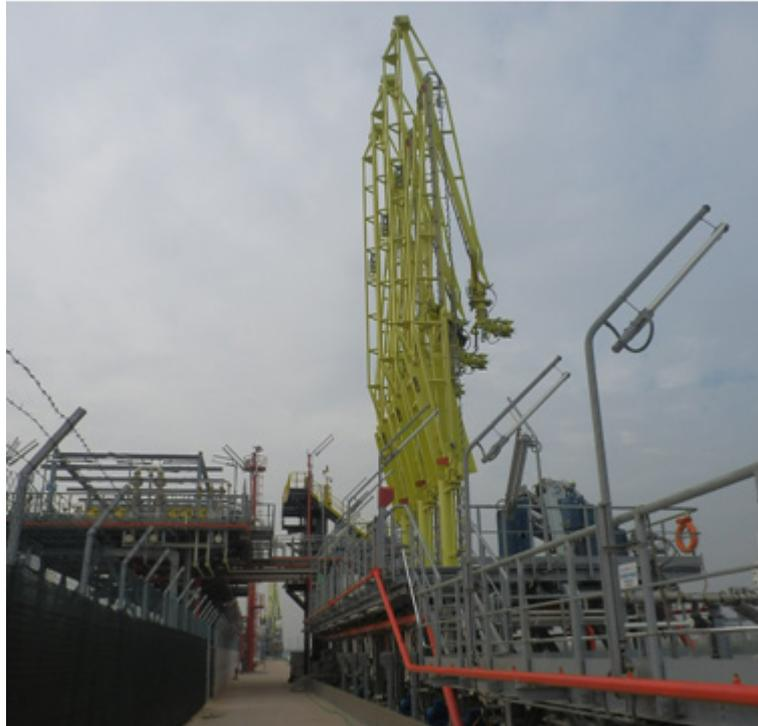
Figura 5.c: Bracci di Carico lungo la Banchina DECAL in prossimità dell'Area di Interesse
