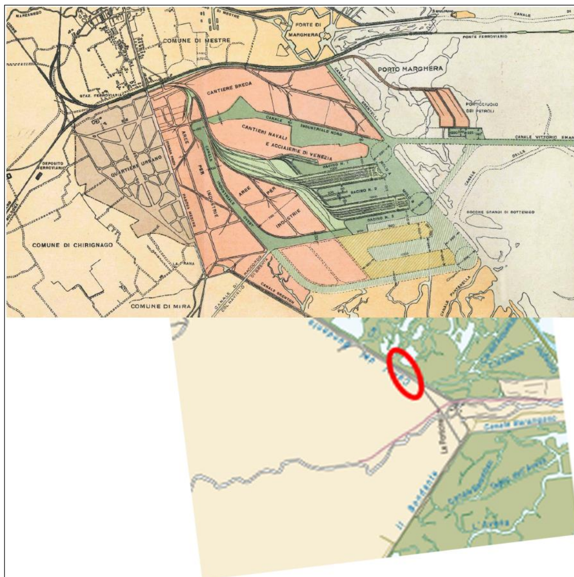
Figura 37. 1917 -Stralcio del progetto dell'ing. Cagli che riguarda il completo assetto della I area industriale e parzialmente della II per la costruzione della nuova sede portuale di Marghera sul bordo lagunare e la Società Porto Industriale di Venezia (Porto Marghera, Antonio Revedin, IUAV 2013 - http://www.iuav.it/Ateneo1/docenti/architetto/docenti-st/Umberto-Tr/materiali-/03-Corso-d/03-1-Prese/2013_10_25_IUAV_storia_porto_marghera.pdf ). Qui sovrapposto alla cartografia del 1900 con indicata l'area di progetto, riporta il canale Bondante di Sopra con l'idronimo Canale Brenton.
