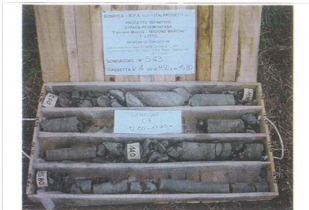
- Sondaggio S43, cassetta catalogatrice n. 4 (da 11.50 m a 15.80 m)
