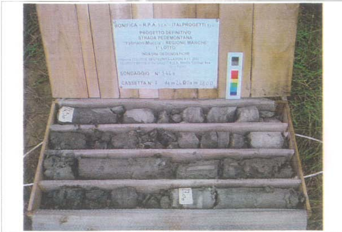
- Sondaggio S44b, cassetta catalogatrice n. 7 (da 24.00 m a 28.00 m)
