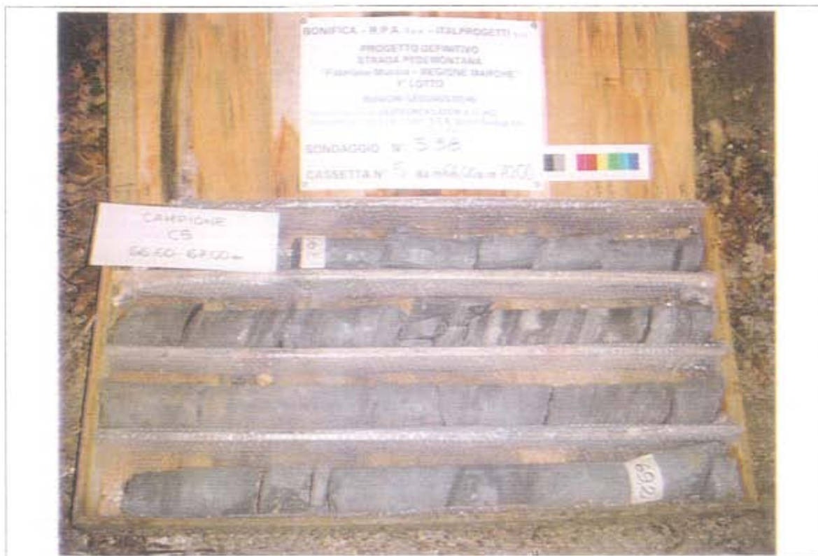
- Sondaggio S38, cassetta catalogatrice n. 5 (da 66.00 m a 70.00 m)
