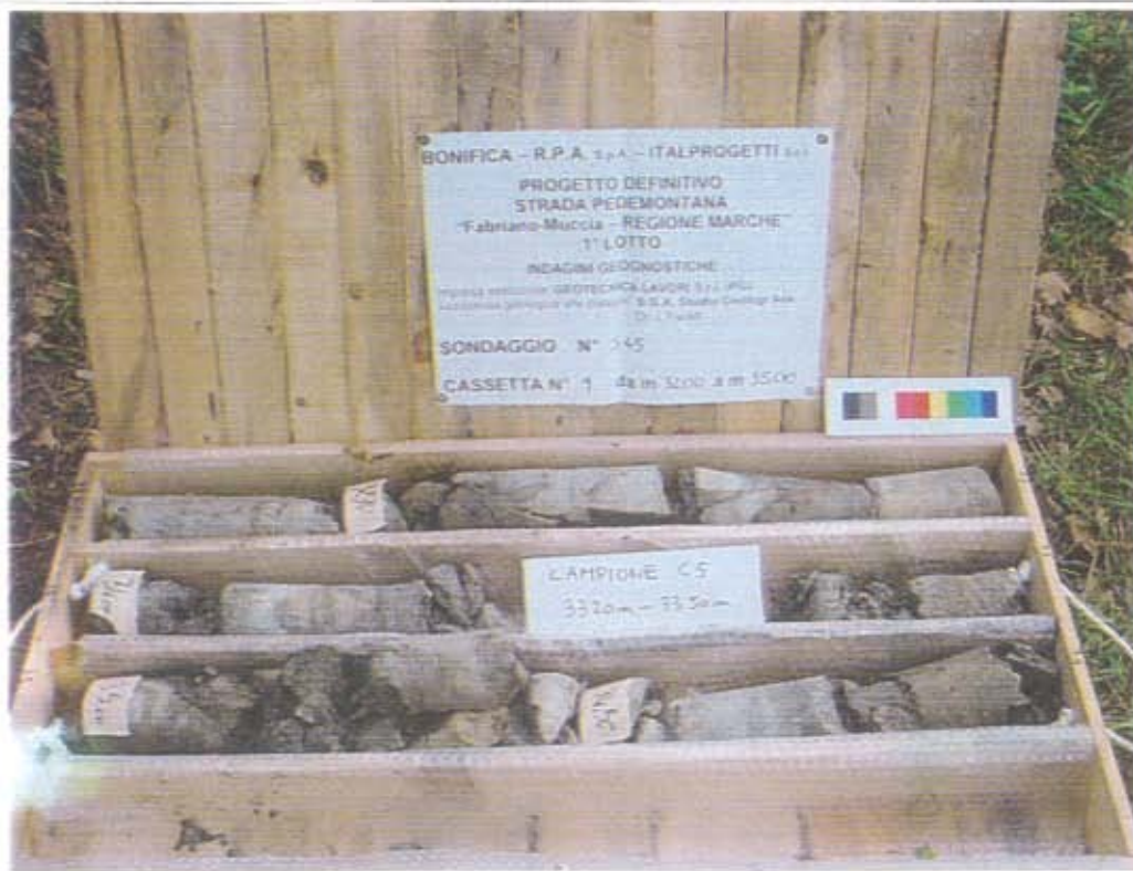
- Sondaggio S45, cassetta catalogatrice n. 9 (da 32.00 m a 35.00 m)
