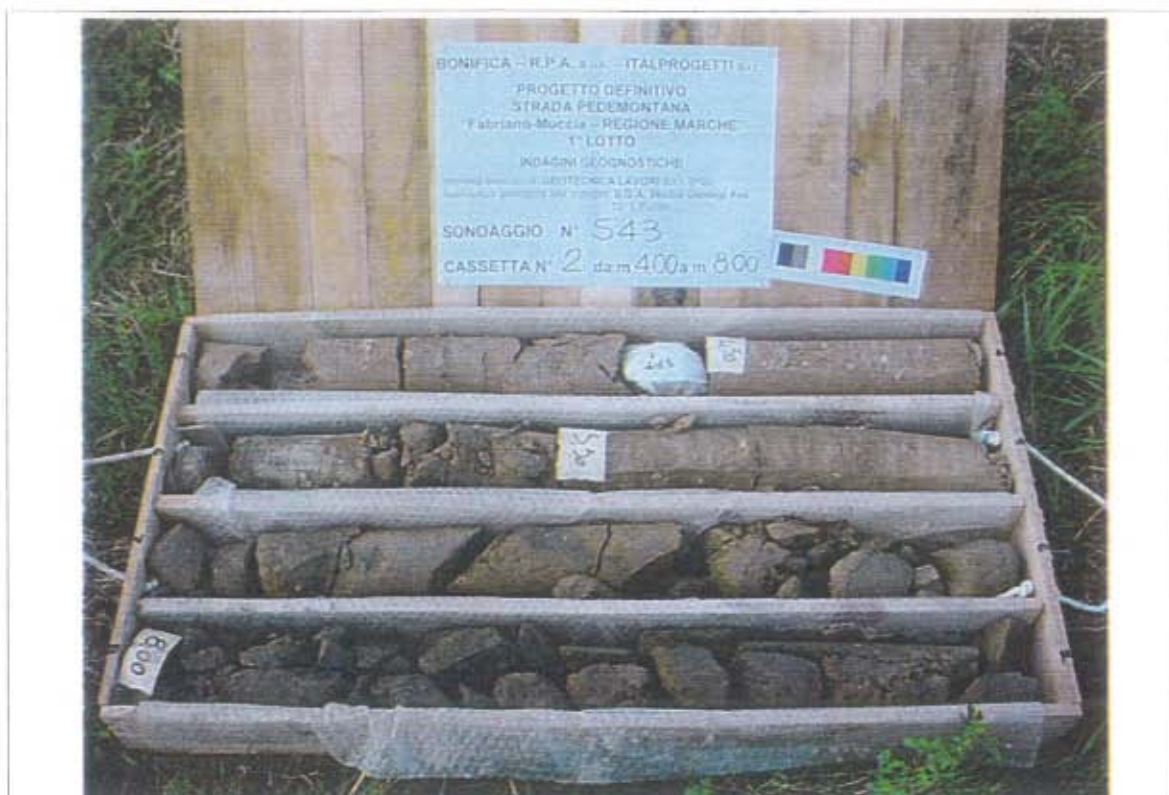
- Sondaggio S43, cassetta catalogatrice n. 2 (da 4.00 m a 8.00 m)
