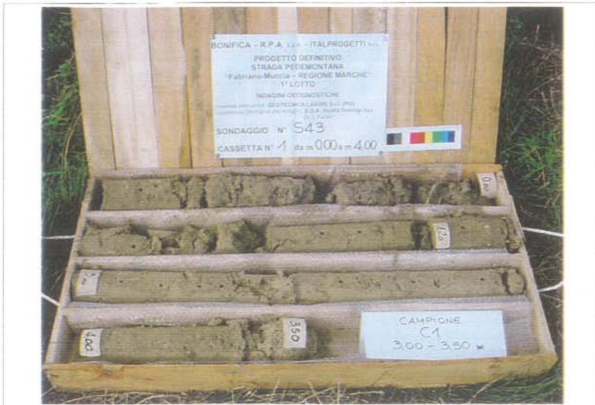
- Sondaggio S43, cassetta catalogatrice n. 1 (da 0.00 m a 4.00 m)
