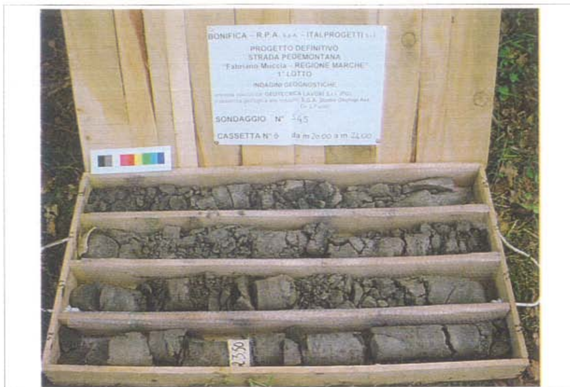
- Sondaggio S45, cassetta catalogatrice n. 6 (da 20.00 m a 24.00 m)
