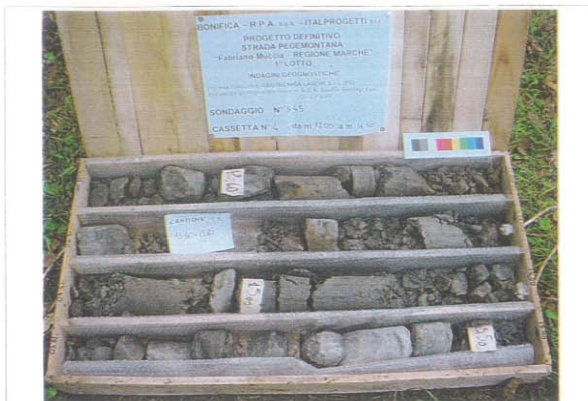
- Sondaggio S45, cassetta catalogatrice n. 4 (da 12.00 m a 16.50 m)
