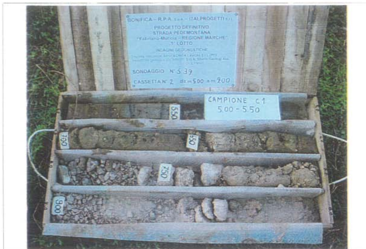
- Sondaggio S39, cassetta catalogatrice n. 2 (da 5.00 m a 9.00 m)
