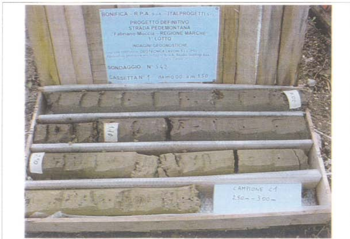
- Sondaggio S42, cassetta catalogatrice n. 1 (da 0.00 m a 3.50 m)
