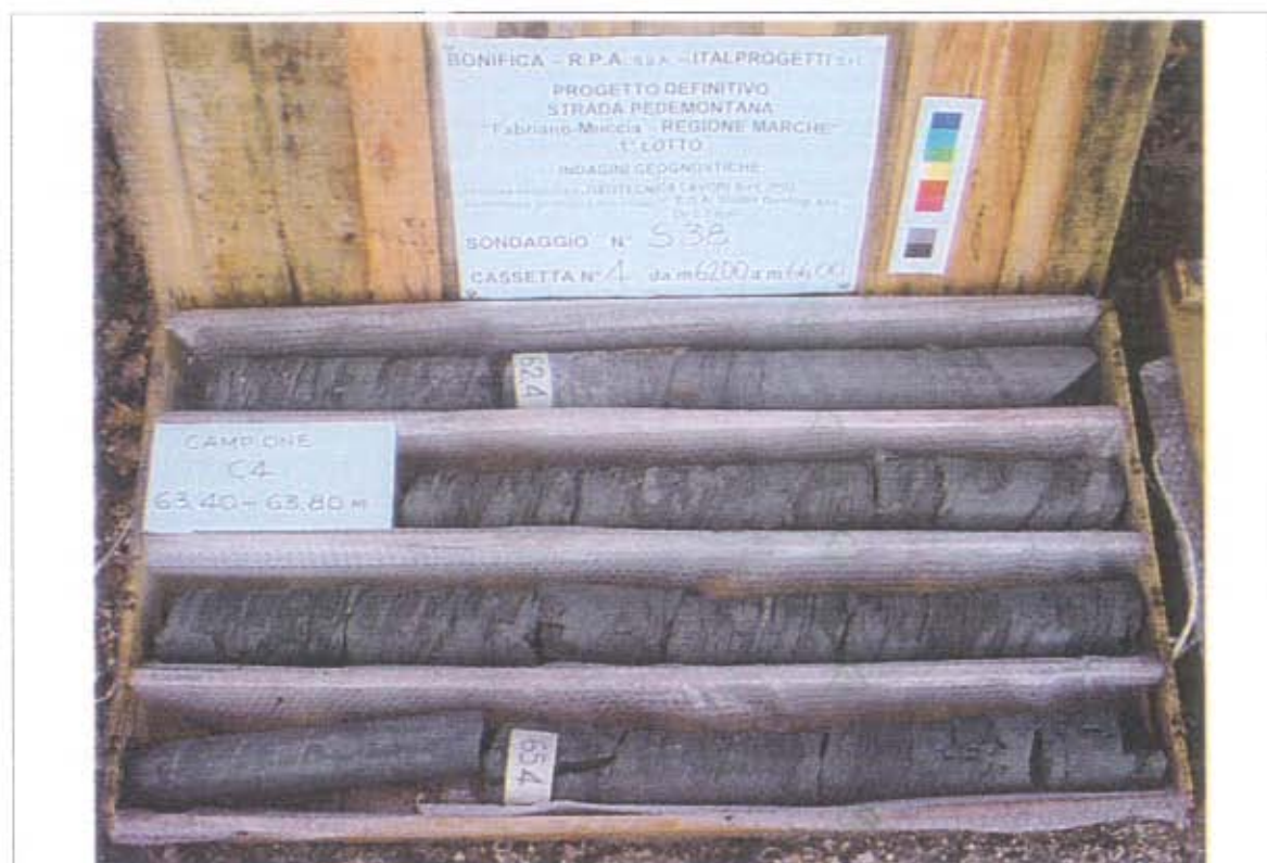
- Sondaggio S38, cassetta catalogatrice n. 4 (da 62.00 m a 66.00 m)
