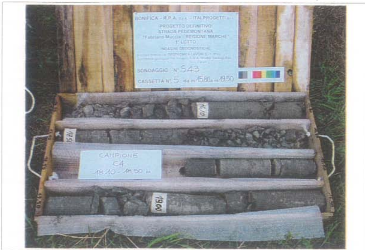
- Sondaggio S43, cassetta catalogatrice n. 5 (da 15.80 m a 19.50 m)
