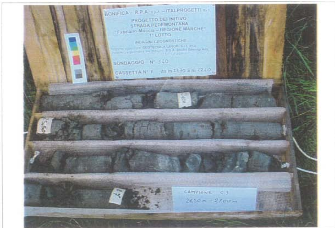
- Sondaggio S40, cassetta catalogatrice n. 7 (da 23.70 m a 27.40 m)
