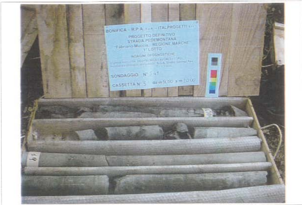
- Sondaggio S41, cassetta catalogatrice n. 5 (da 16.00 m a 20.00 m)
