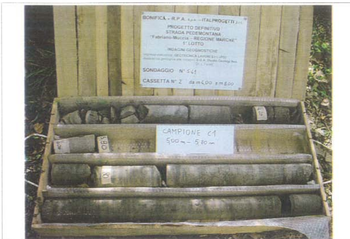
- Sondaggio S41, cassetta catalogatrice n. 2 (da 4.00 m a 8.00 m)
