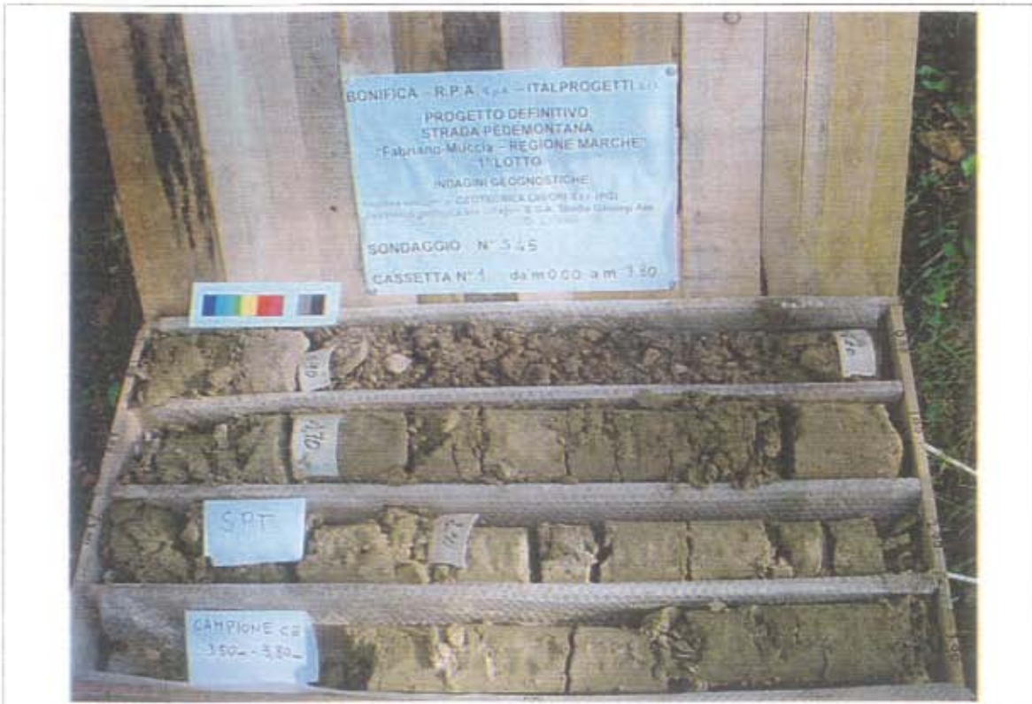
- Sondaggio S45, cassetta catalogatrice n. 1 (da 0.00 m a 3.80 m)
