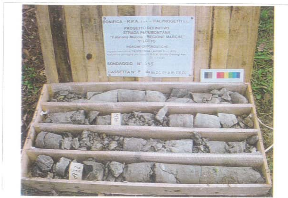
- Sondaggio S45, cassetta catalogatrice n. 7 (da 24.00 m a 28.00 m)
