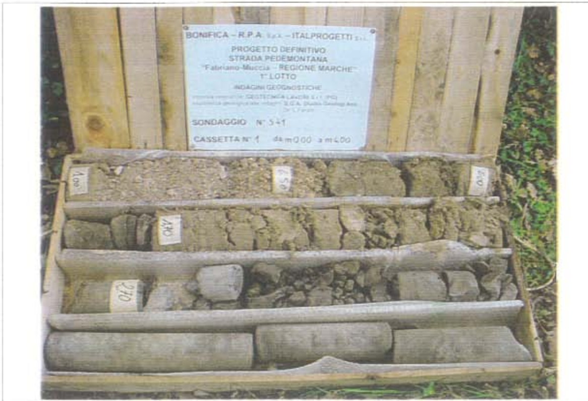
- Sondaggio S41, cassetta catalogatrice n. 1 (da 0.00 m a 4.00 m)
