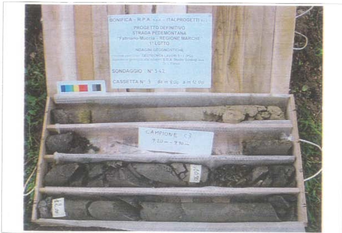
- Sondaggio S42, cassetta catalogatrice n. 3 (da 8.00 m a 12.00 m)
