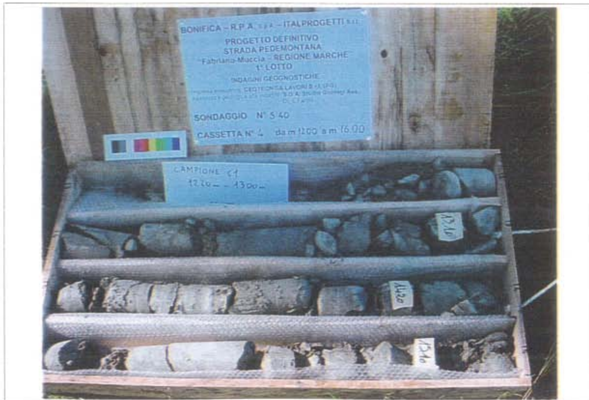
- Sondaggio S40, cassetta catalogatrice n. 4 (da 12.00 m a 16.00 m)
