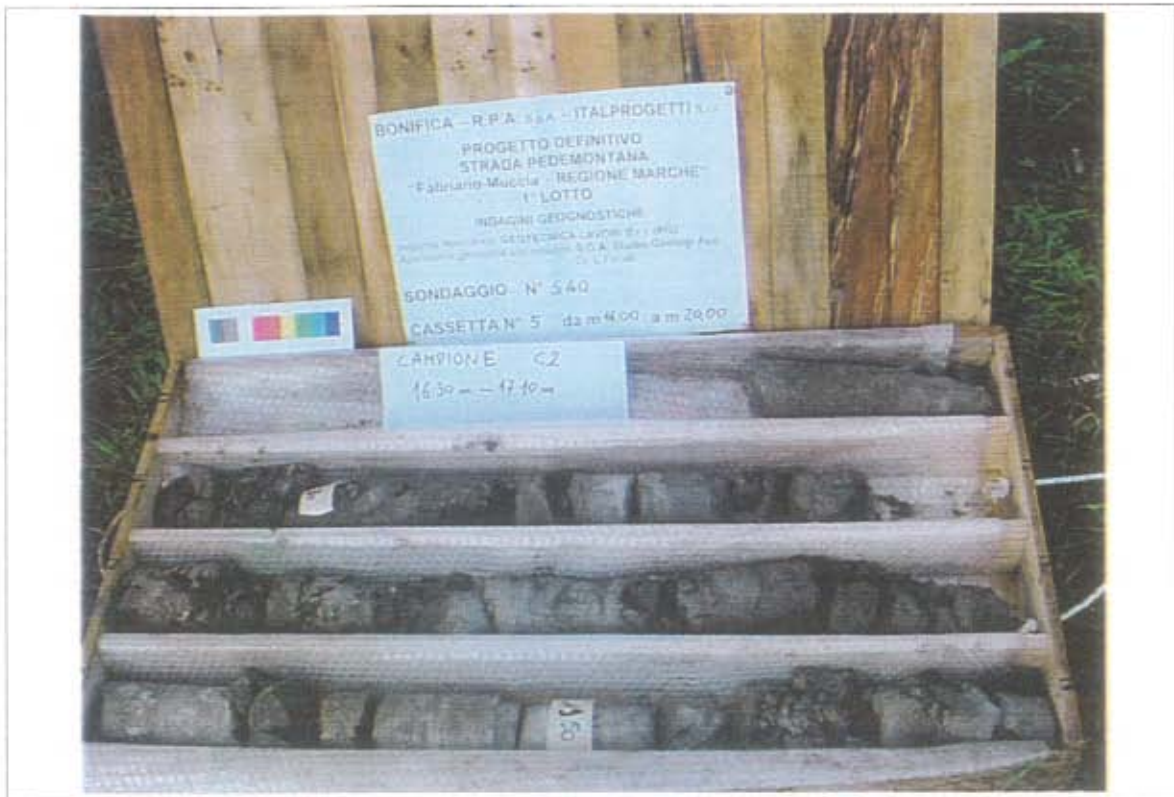
- Sondaggio S40, cassetta catalogatrice n. 5 (da 16.00 m a 20.00 m)
