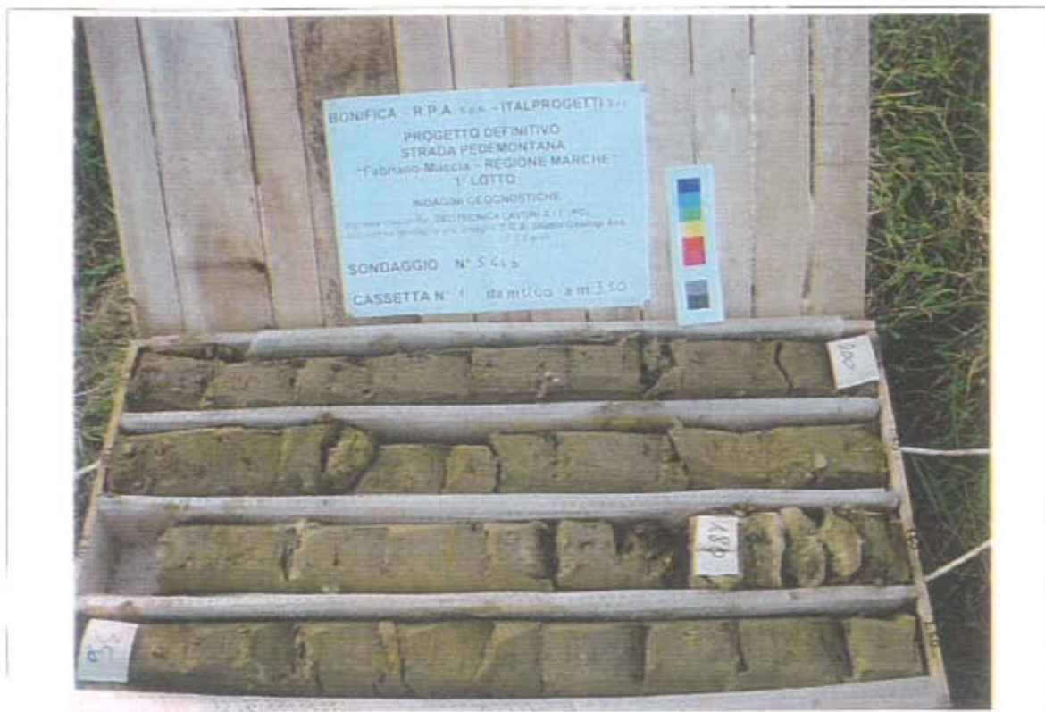
- Sondaggio S44b, cassetta catalogatrice n. 1 (da 0.00 m a 3.50 m)
