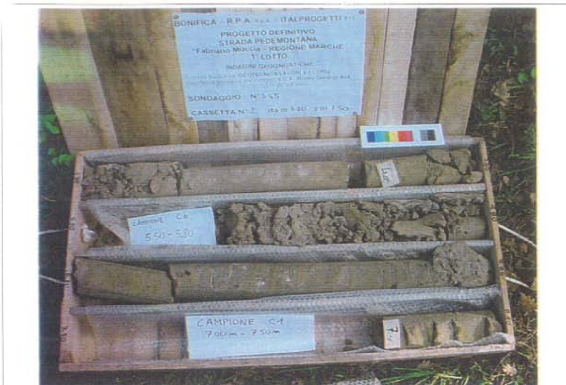
- Sondaggio S45, cassetta catalogatrice n. 2 (da 3.80 m a 7.50 m)
