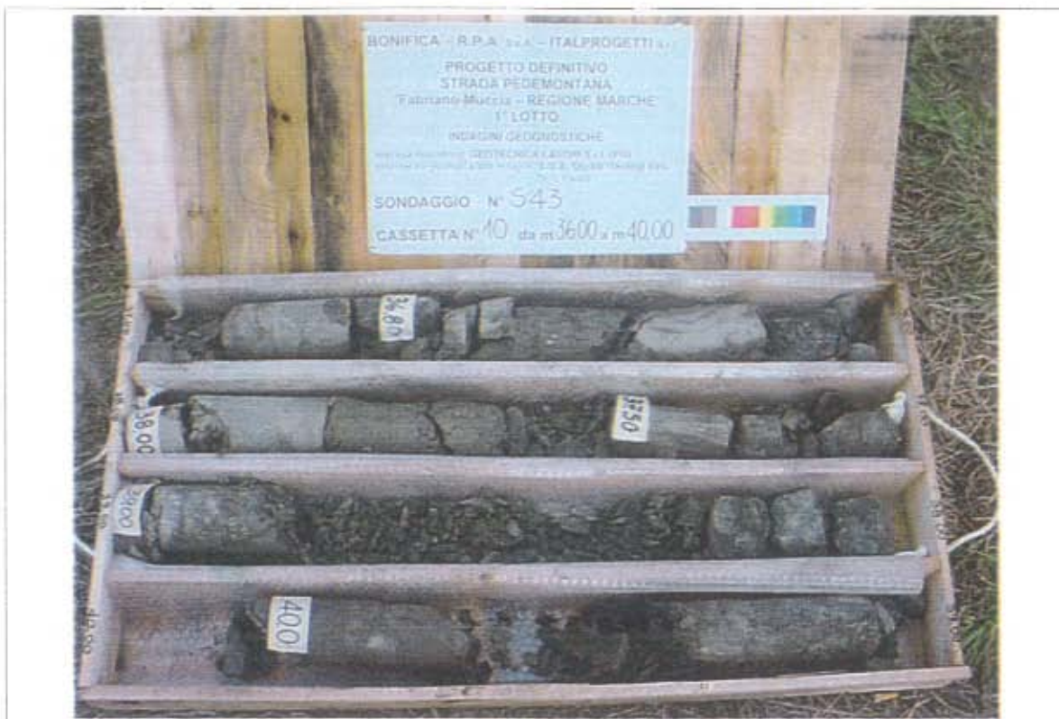
- Sondaggio S43, cassetta catalogatrice n. 10 (da 36.00 m a 40.00 m)
