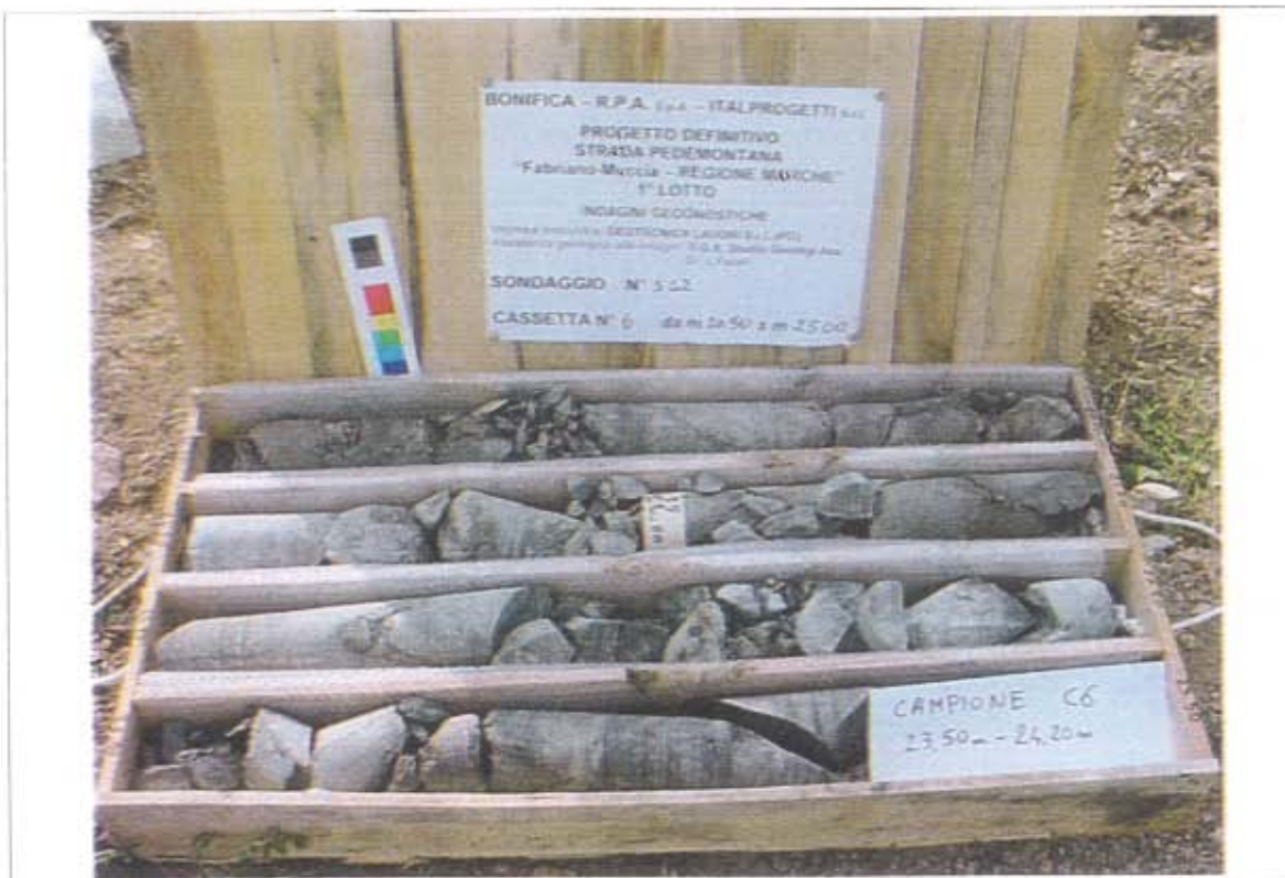
- Sondaggio S42, cassetta catalogatrice n. 6 (da 20.50 m a 25.00 m)
