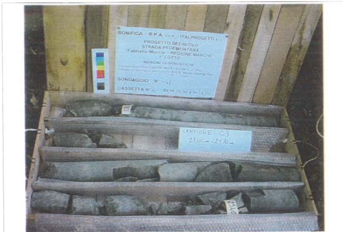
- Sondaggio S41, cassetta catalogatrice n. 6 (da 20.00 m a 24.00 m)
