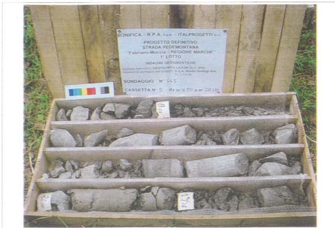
- Sondaggio S45, cassetta catalogatrice n. 5 (da 16.50 m a 20.00 m)
