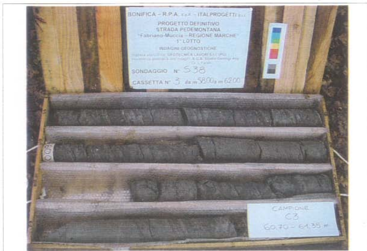
- Sondaggio S38, cassetta catalogatrice n. 3 (da 58.00 m a 62.00 m)
