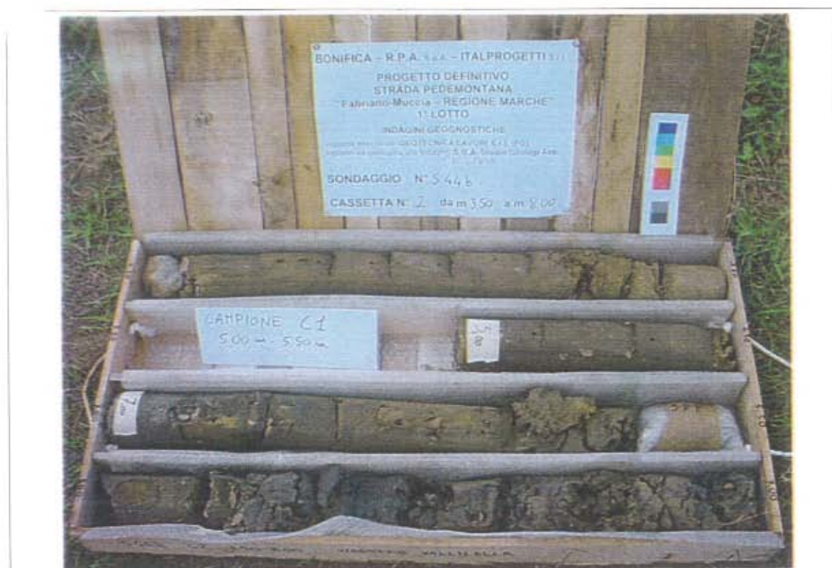
- Sondaggio S44b, cassetta catalogatrice n. 2 (da 3.50 m a 8.00 m)
