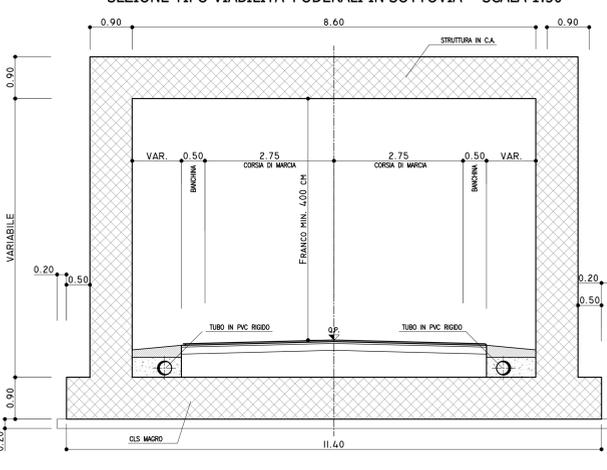
SEZIONE TIPO VIABILITA' IN AFFIANCAMENTO IN RILEVATO
