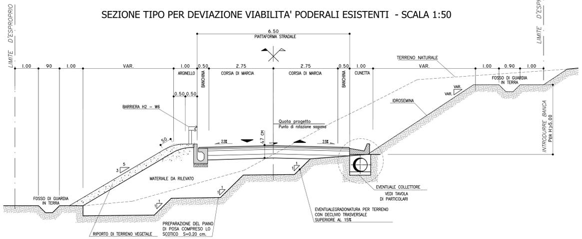
SEZIONE TIPO VIABILITA' SECONDARIA F2 IN SOTTOVIA - SCALA 1:50
