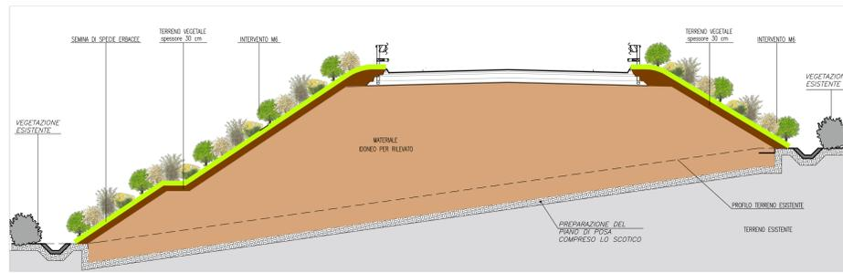
SEZIONE TIPO IN RILEVATO - SCALA 1:100
