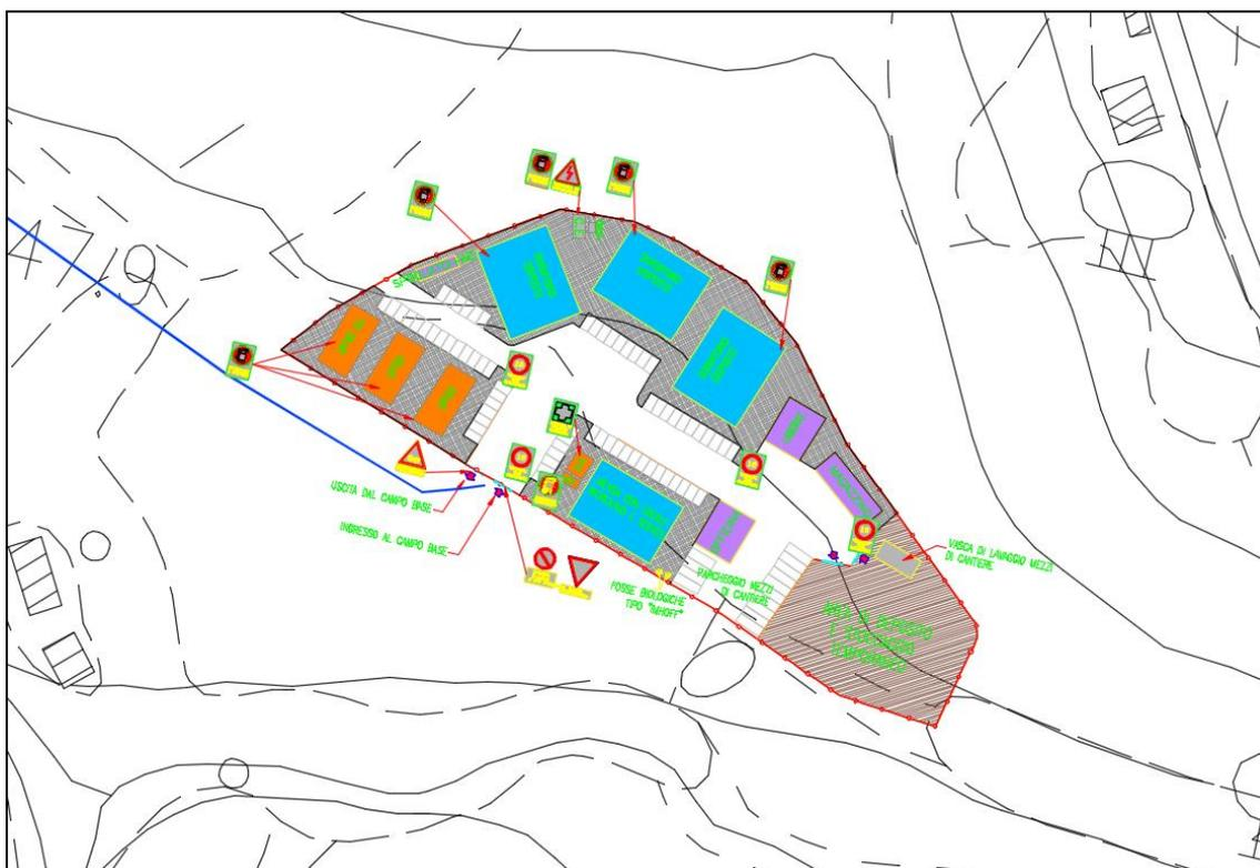
Nelle aree di accumulo è previsto di accantonare i volumi di scavo con scarpa 1/1 fino ad un'altezza di m 2; altezze superiori sono consentite con interposta banca, il massimo consentito è pari ad altezza di m 4. Le superfici di accumulo sono state previste soprattutto a margine degli imbocchi di gallerie.
