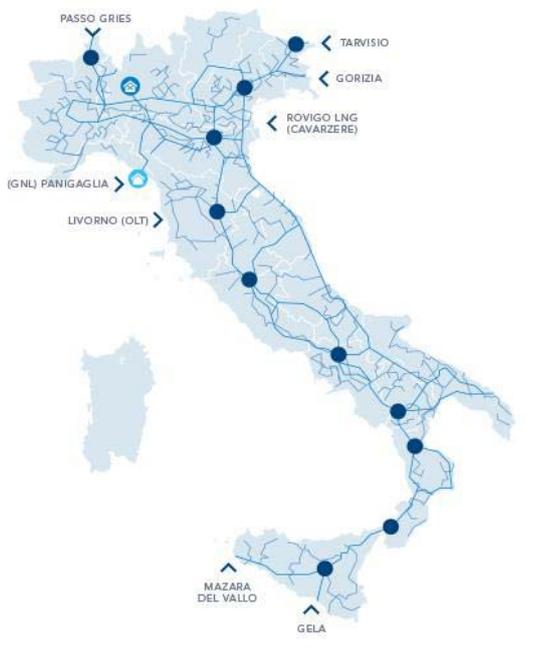
Figura 1 - Rete di distribuzione Gas, i pallini blu rappresentano le centrali di compressione SNAM poste sulla dorsale della rete
