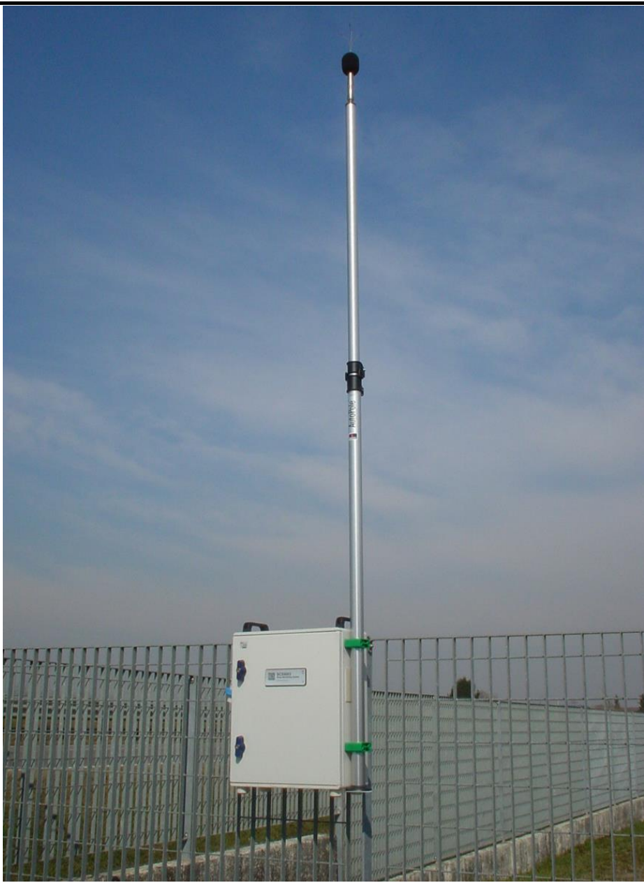
Figura 5.2 Esempio di Centralina di Monitoraggio del Rumore
