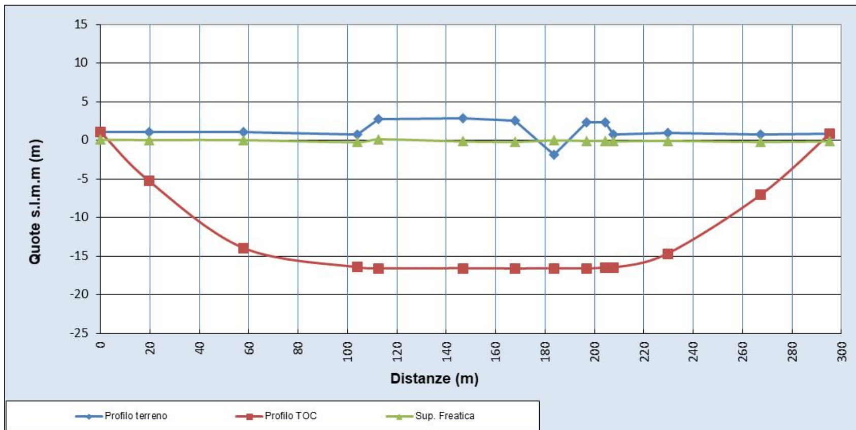
Figura 11 –Sezione schematica del terreno e della T.O.C. (entrata della trivellazione a sinistra)
