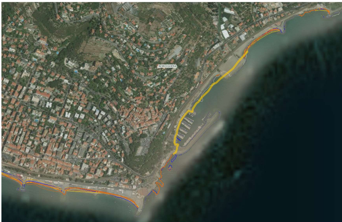
Figura 18: Dopo la creazione delle principali opere antropiche costiere (1973, 1983; 1993; 2003; 2013), l'evoluzione della linea di costa è estremamente limitata, con tendenze erosive tranne che a Capo S. Ampeglio.
