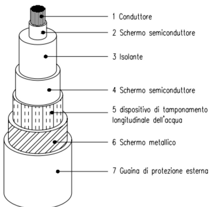
**Fig. 1** - Tipico di un cavo ad isolamento estruso da 1600 mm<sup>2</sup>
