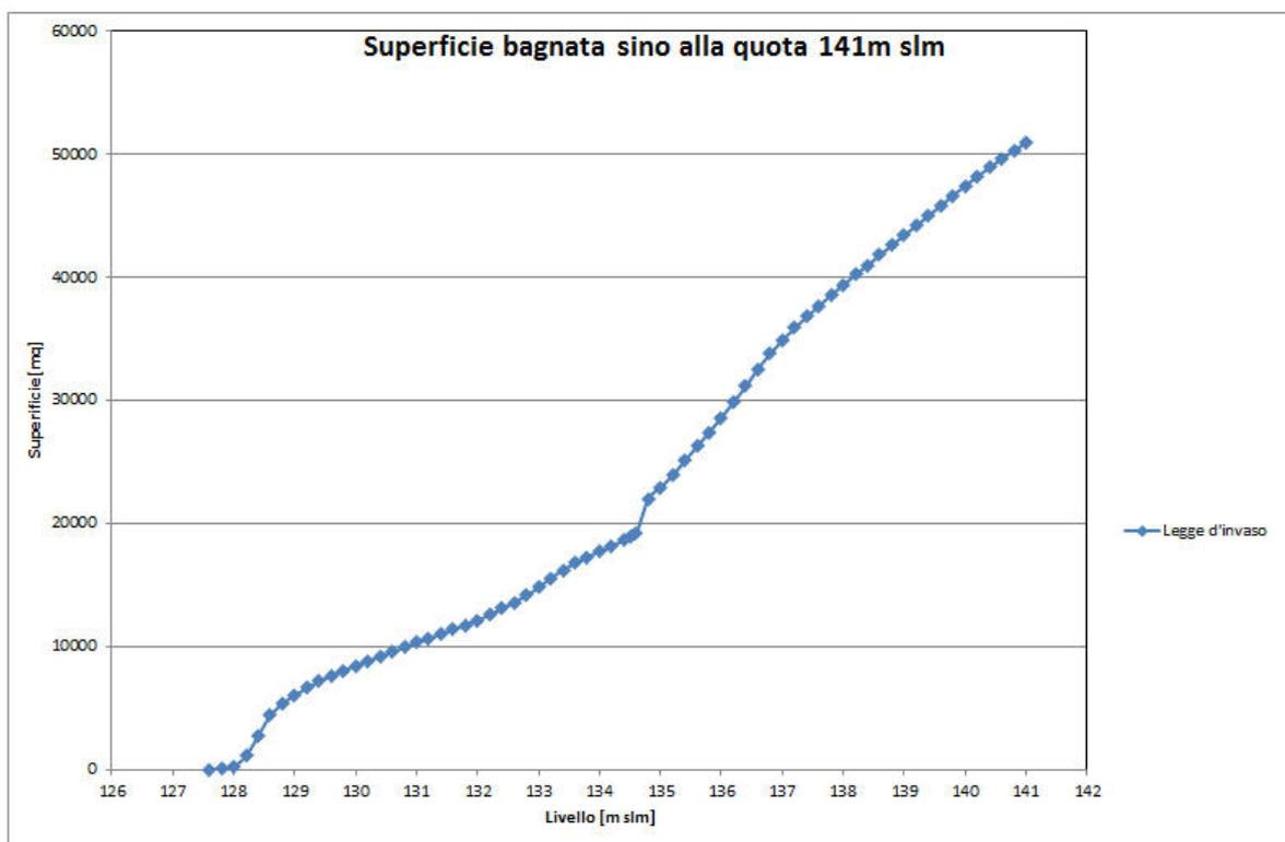
Figura 28 - Legge quota - superficie d'invaso (rilievo 2012) sino alla quota 141 m slm.
