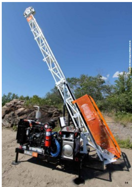
Figura 2: Sonda DB LF70. Questo particolare si riferisce al rettangolo "SONDA" di figura 1.
