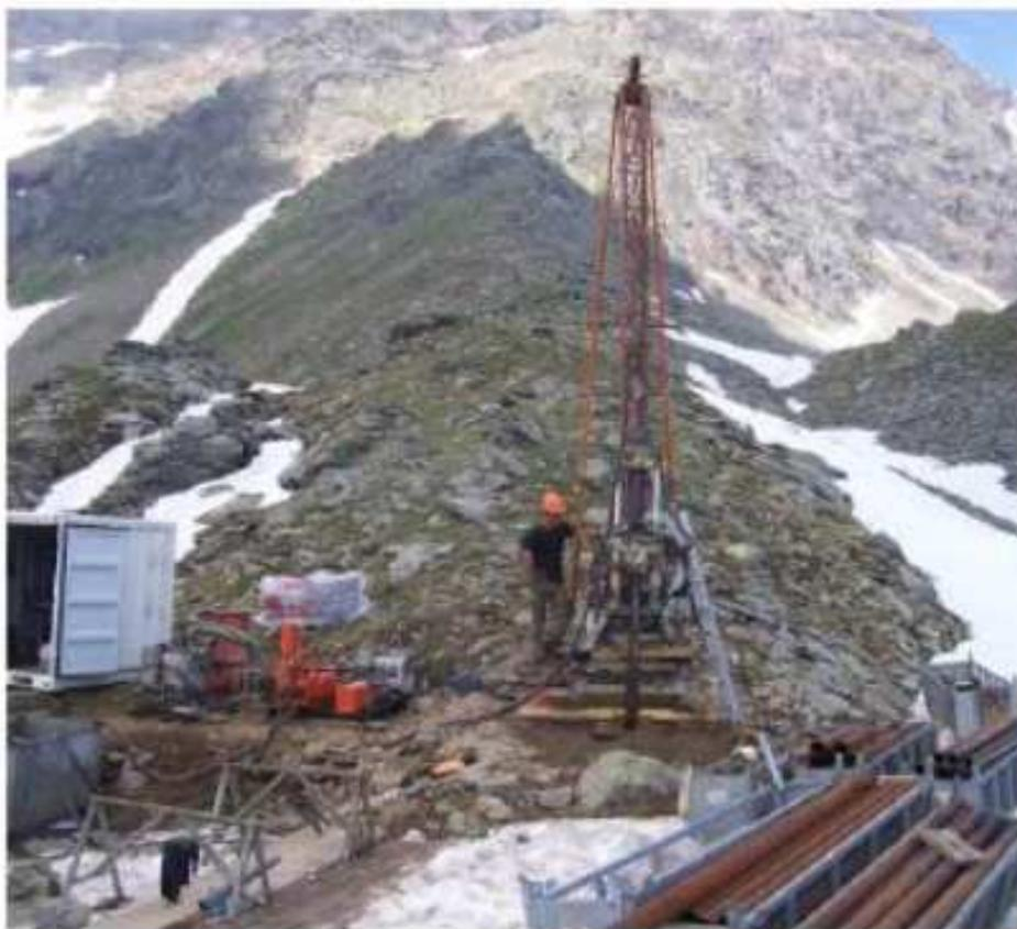
**Foto 13:** Sonda Longyear 34 per carotaggio in ambiente montano.
