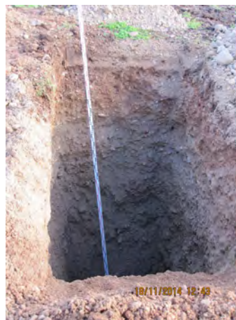
Scavo trincea 12TRe (da m 0,00 a m 3,50)
