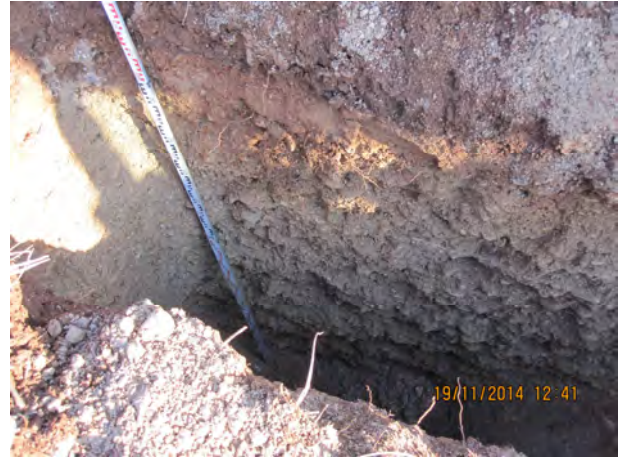
Scavo trincea 04TRe (da m 0,00 a m 3,50)
