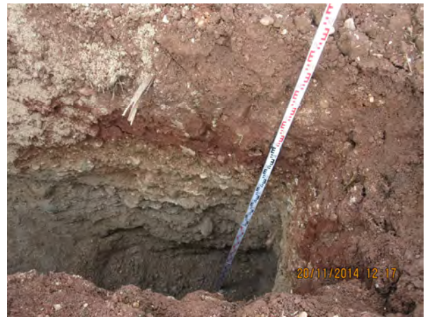
Scavo trincea 15TRe (da m 0,00 a m 3,50)
