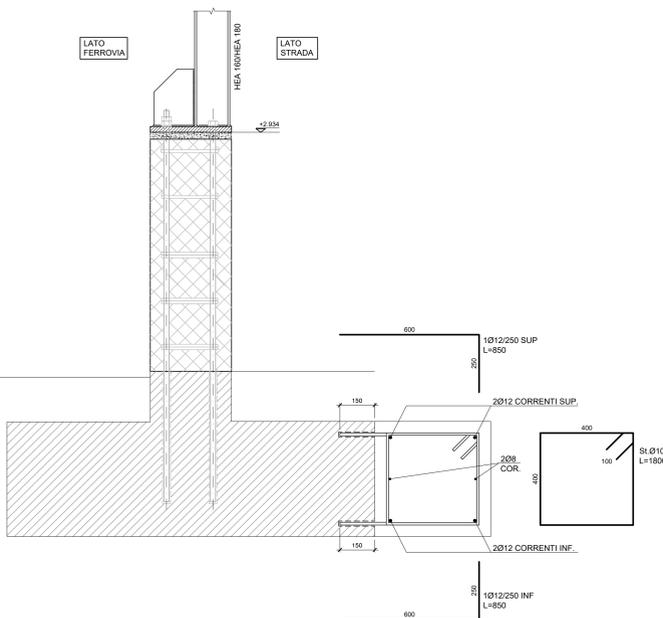
SEZIONE M2-M244 (MONTANTI M02 E M244) PARTE CIECA
