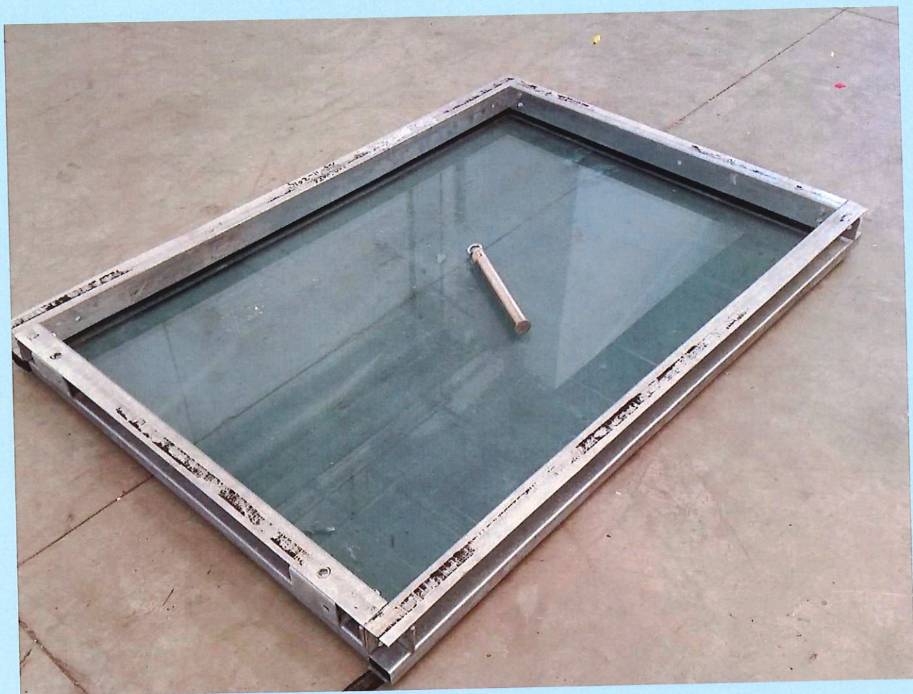
Fotografia del campione con il percussore sulla superficie soggetta all'urto.
