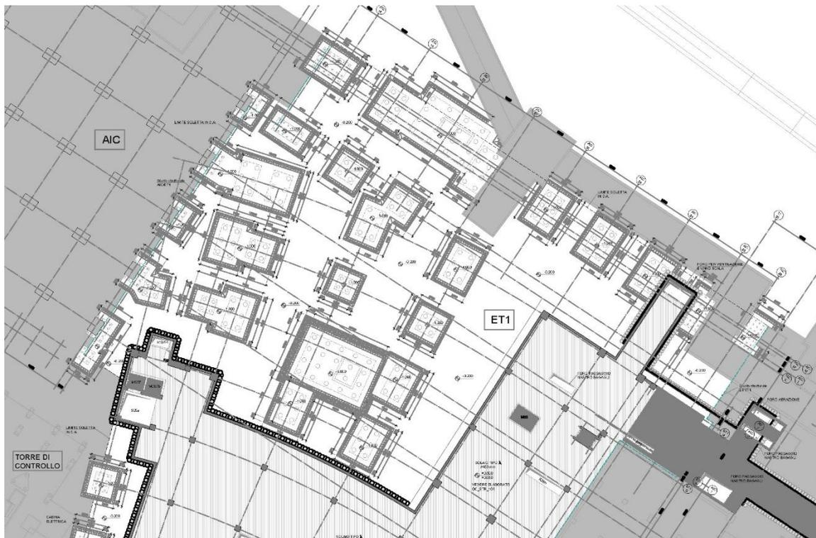
Figura 2-2 : planimetria degli scavi previsti per la realizzazione dei plinti di fondazione dell'ET1
