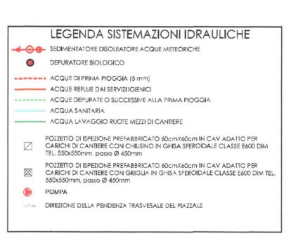
I tubi a gravità delle reti meteoriche sono in PEAD serie SN8. I tubi a gravità della fognatura nera sono in PEAD SN 8. I tubi delle reti in pressione sono in polietilene alta densita PE 100, PN 10. Le pendenze dei tubi di piccolo diametro, se non espliciatamente indicato, sono da assumersi con valore minimo dell'0.2%.
