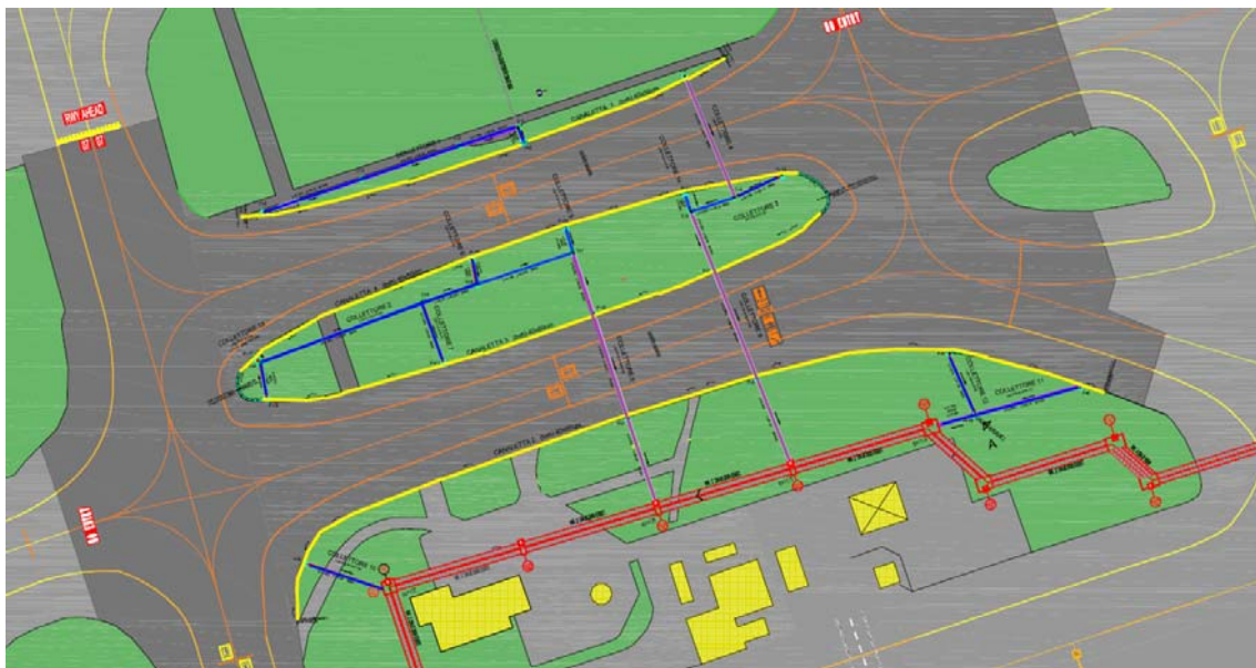
Figura 3-1 Planimetria degli interventi di progetto nella zona di intervento del Lotto A. In grigio e rosso è indicato il NCN realizzato nell'ambito dei lavori di mitigazione del rischio idraulico in area ovest, in verde i collettori in PP-HM SN16 e in azzurro, blu e viola le canalette
