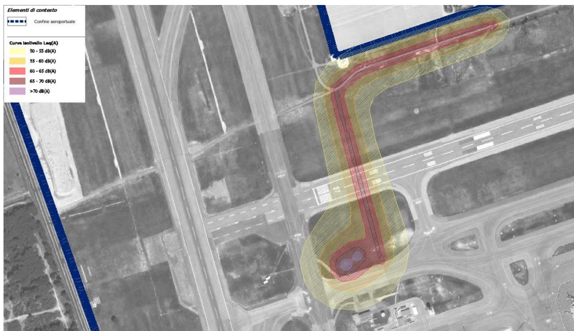
Figura 7-15 Curve di isolivello acustico indotte da sorgenti di cantiere e dal trasporto dei materiali, nel periodo notturno
