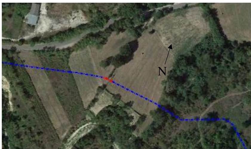
Fig.1 – inquadramento su ortofoto della variante per sostituzione giunto a flangia (in rosso l'intervento in progetto) nel comune di Rosciano (PE), in blu il metanodotto esistente.
