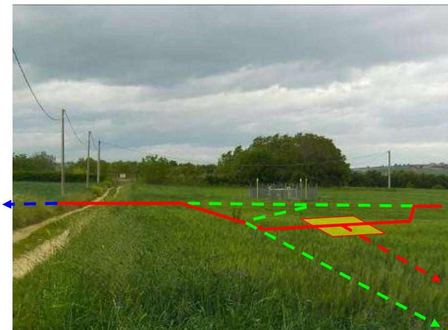
Foto n.4 – PIDI n.43430/3 esistente da dismettere, Variante per inserimento PIDI n.1 DN 400 (16”) (in rosso), Ricollegamento Met. Der. n.1 di Alanno DN 100 (4”) (in rosso tratteggiato), il metanodotto esistente (in blu) e le dismissioni connesse (in verde)
