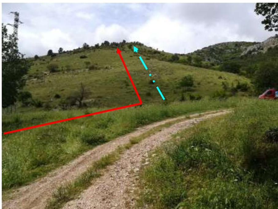
Foto n.14 – Variante per attraversamento Fiume Tirino DN 400 (16'') (in rosso) e metanodotto SGI DN 500 (in azzurro)
