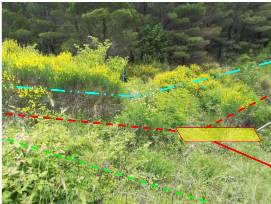
Foto n.19 – PIDI n.9 in progetto, Variante Derivazione Ricollegamento per Sulmona, DN 150 (6”) (in rosso) e la sua dismissione (verde tratteggiato), Variante per attraversamento Fiume Tirino DN 400 (16”) (in rosso tratteggiato), metanodotto SGI DN 500 (in azzurro), metanodotto Chieti-Rieti DN 400 (16”) esistente (blu tratteggiato)
