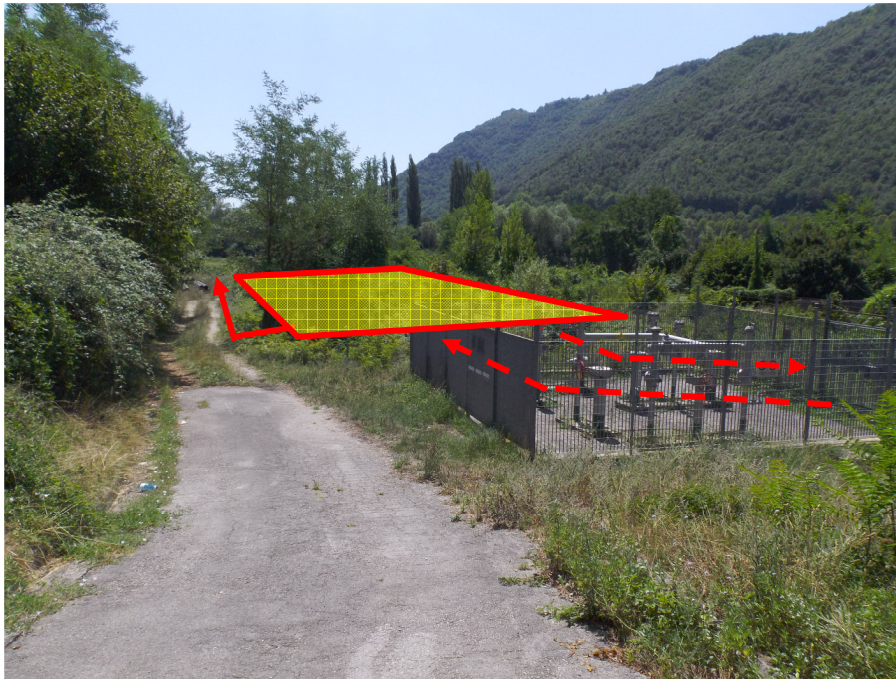
Foto n.27 – Variante per ricollegamento Met. Rieti-Roma DN 300 (12'') (in rosso) all'uscita della nuova trappola di Rieti, PIDI 45430/32 esistente da dismettere, la variante per adeguamento diametro DN 400 (16'') che entra nella trappola e la variante per ricollegamento Met. Rieti-Terni DN 300 (12'') (in rosso tratteggiato)
