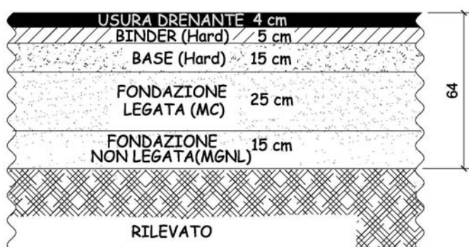
Figura 6 – Sovrastruttura nuove pavimentazioni
