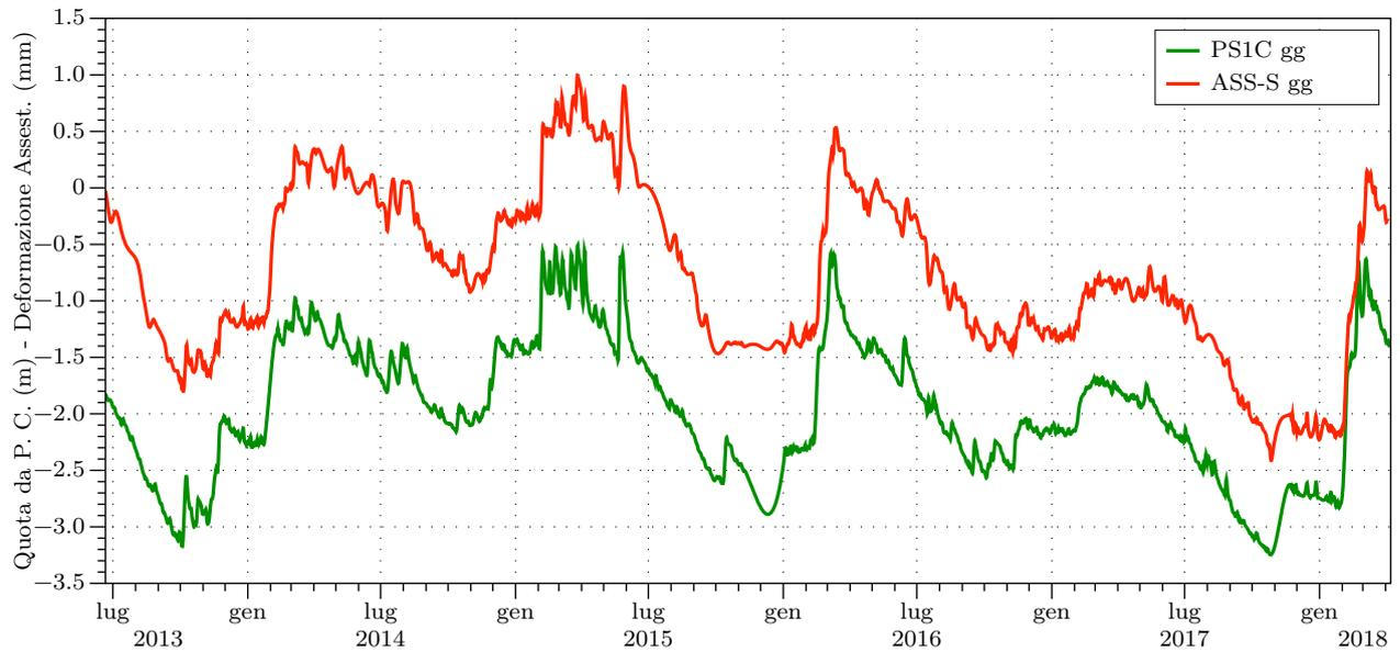
Figura 3.9: Relazione tra le deformazioni giornaliere medie registrate lungo l'asta dell'assestometro superficiale (ASS-S) e le oscillazioni di quota nel piezometro superficiale PS1C, durante l'intero periodo di monitoraggio.
