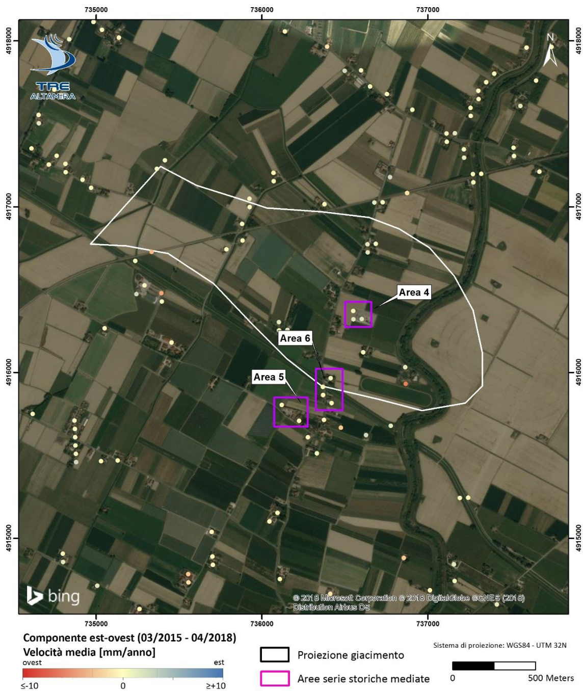
Figura 18: Dettaglio della componente est-ovest nell'area del Pool B. Le serie storiche dei punti all'interno delle aree viola sono stati mediate per ottenere le serie storiche medie mostrate in Figura 20
