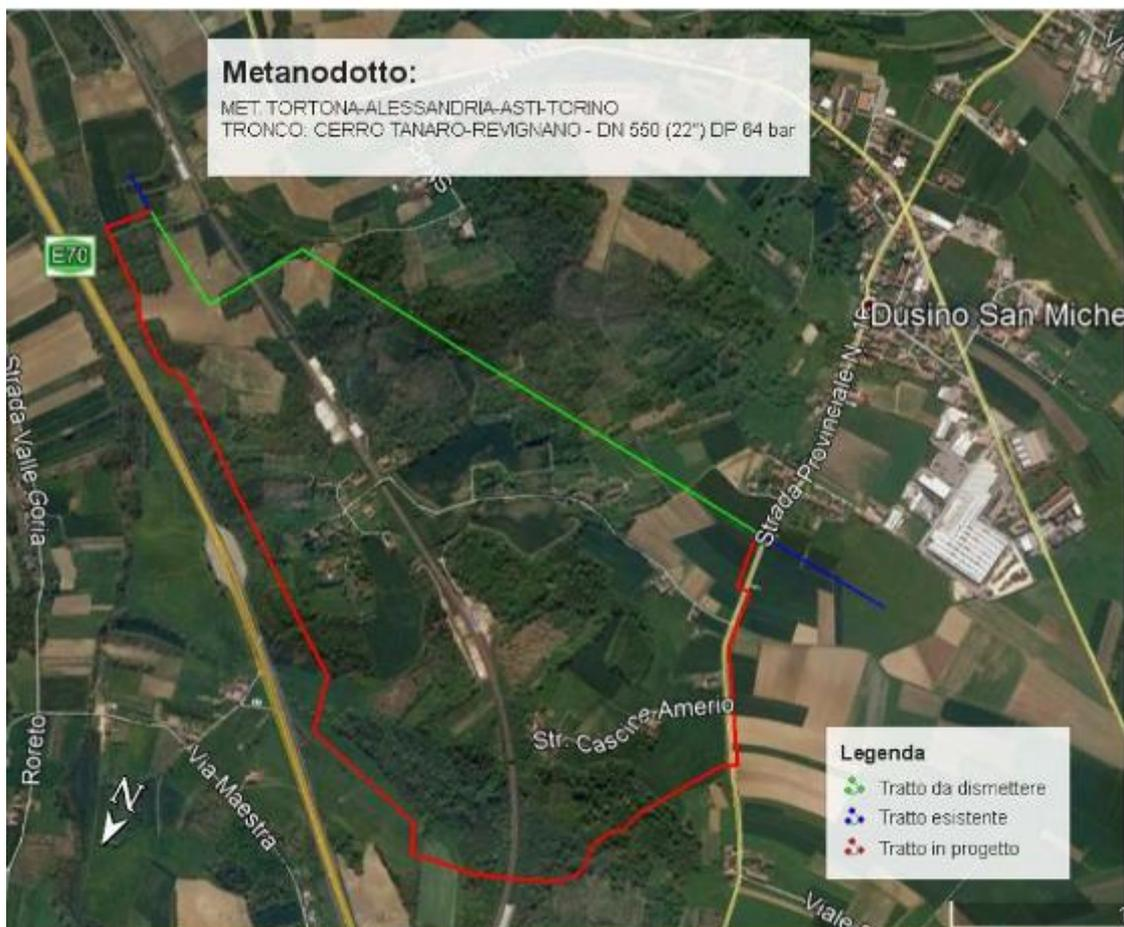
**Fig. 3/B** – Stralcio immagine aerea con localizzazione delle aree d'intervento (in rosso il tracciato di progetto, in verde il tracciato in dismissione, in blu quello in esercizio)
