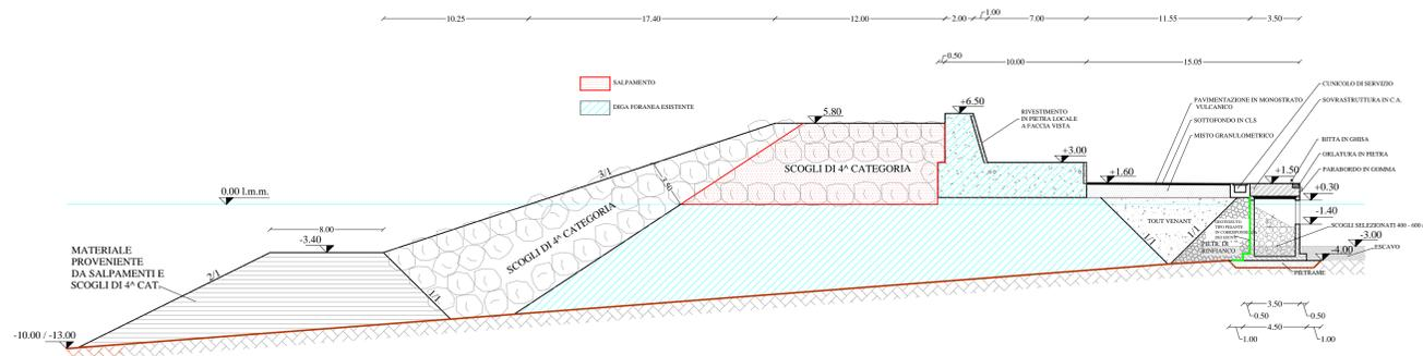
SEZIONE TIPO DIGA FORANEA DI SOPRAFLUTTO
