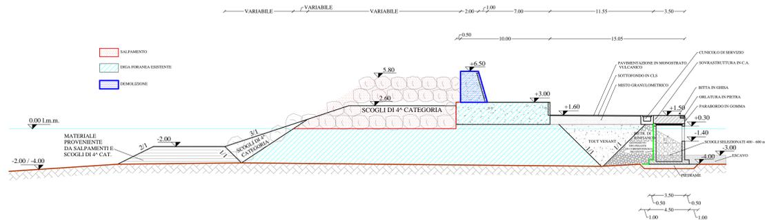
SEZIONE TIPO DIGA FORANEA DI SOPRAFLUTTO
