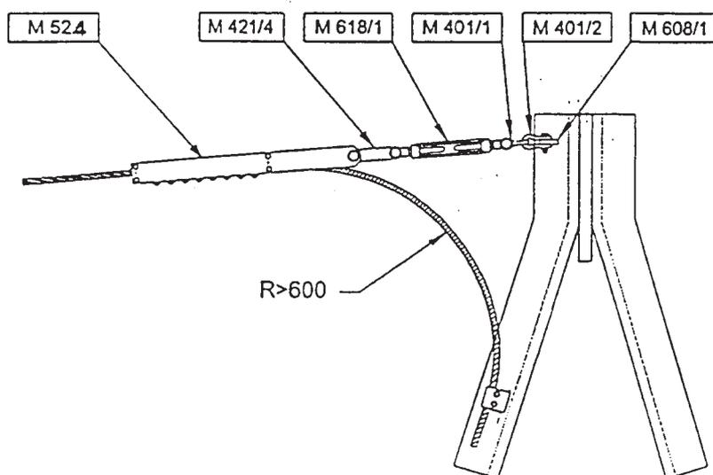
Nota: Le quantità dei morsetti bifilari M 1027 e delle staffe di fissaggio M 600 per la discesa della fune di guardia alla scatola di giunzione devono essere specificate in funzione del tipo ed altezza del sostegno sul quale viene realizzata la discesa.
