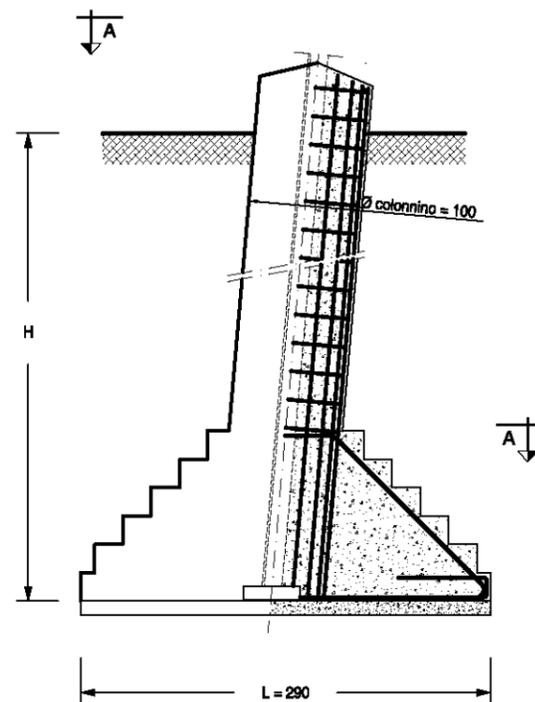
**PIANTA - SEZIONE A-A PLINTO FONDAZIONE**
