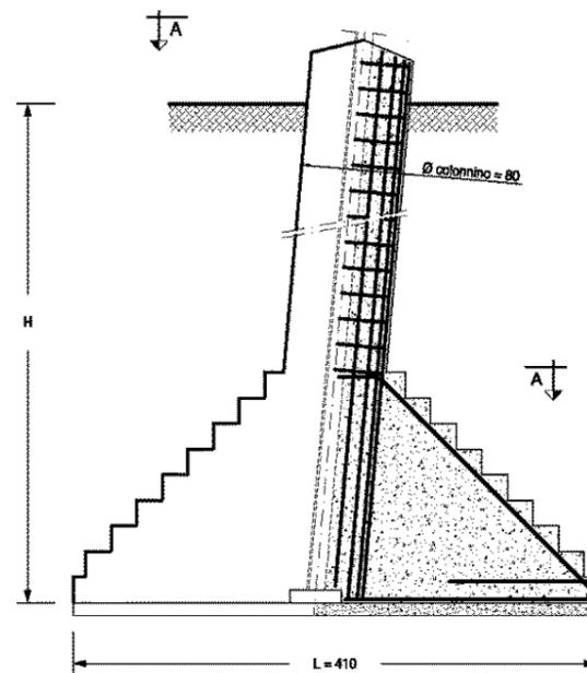
PIANTA - SEZIONE A-A PLINTO FONDAZIONE
