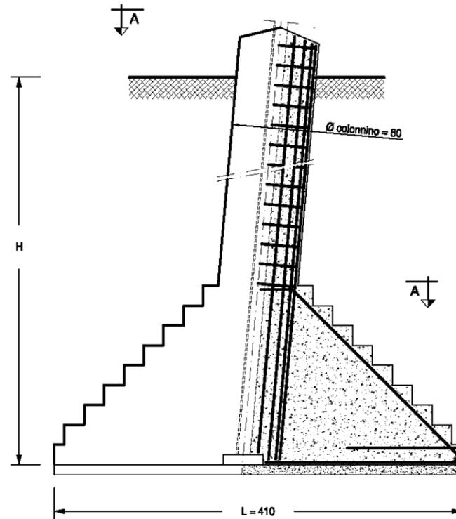
**PIANTA - SEZIONE A-A PLINTO FONDAZIONE**
