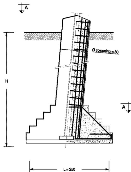
**PIANTA - SEZIONE A-A PLINTO FONDAZIONE**
