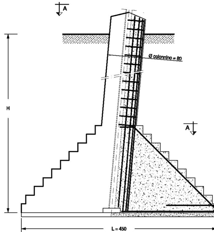
**PIANTA - SEZIONE A-A PLINTO FONDAZIONE**
