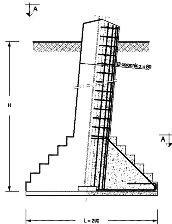
**PIANTA - SEZIONE A-A PLINTO FONDAZIONE**
