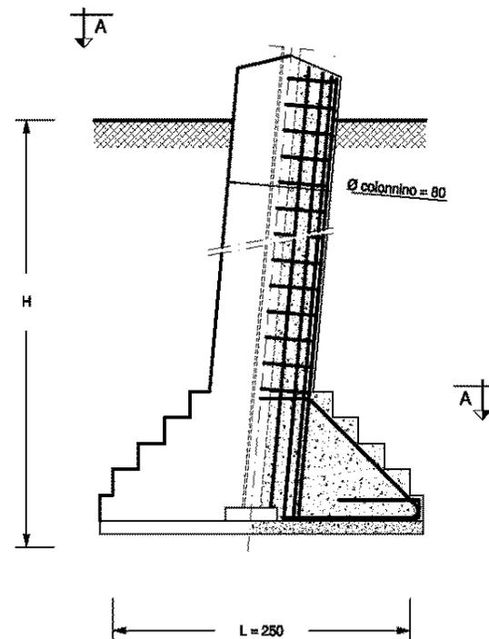
**PIANTA - SEZIONE A-A PLINTO FONDAZIONE**
