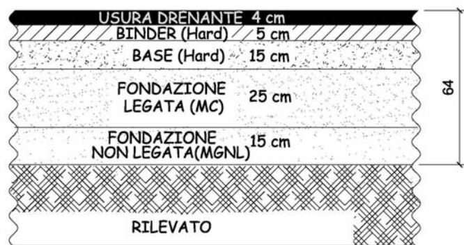
Figura 10 – Sovrastruttura nuove pavimentazioni
