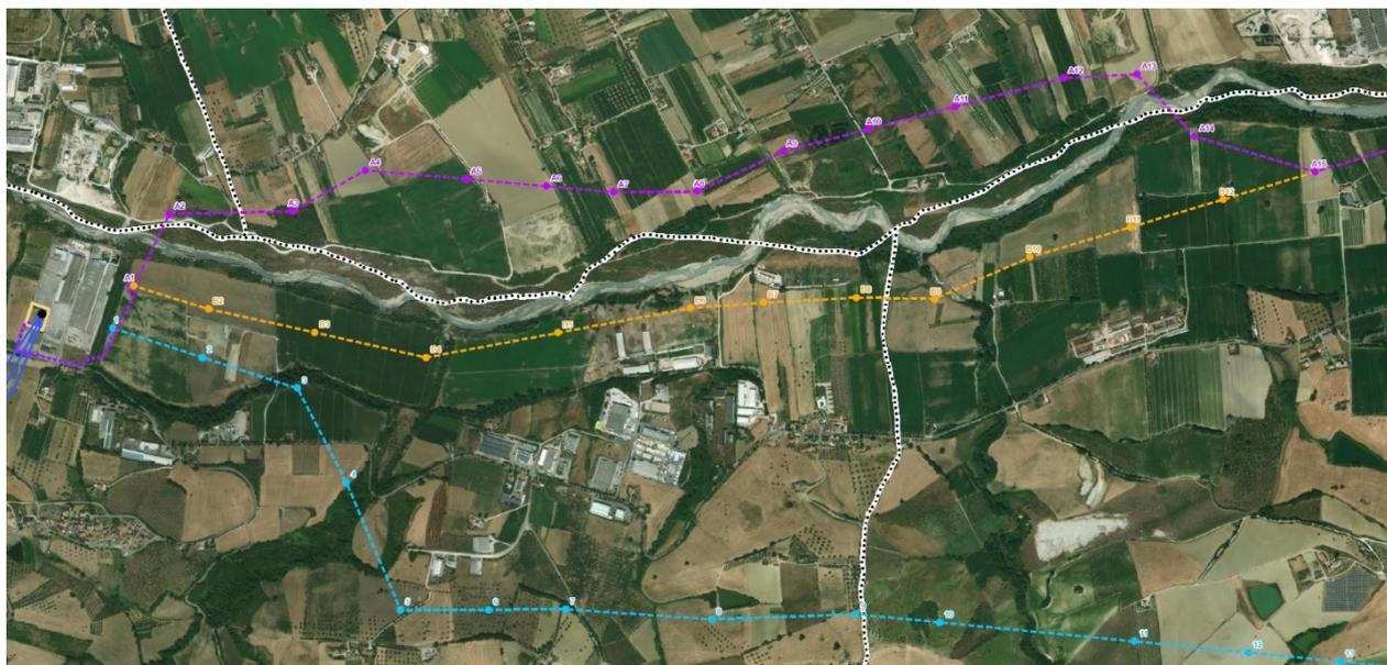
**Figura 16 - Alternativa A - elettrodotto aereo a 132 kV Cellino – Roseto tratto A1-A15**
