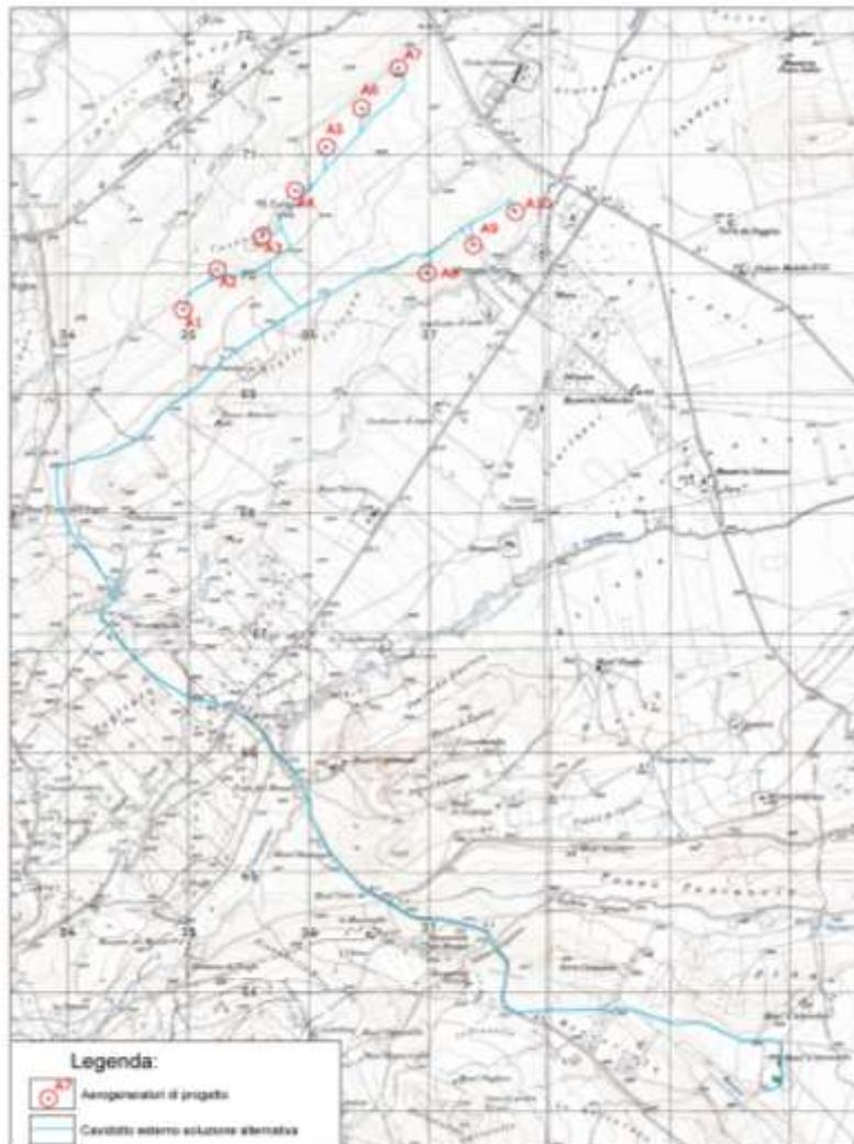
**Figura 21 – layout d’impianto con soluzione alternativa per il collegamento MT (in ciano il collegamento MT)**
