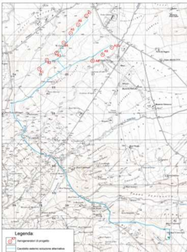
Figura 2 – layout d’impianto con soluzione alternativa per il collegamento MT (in ciano il collegamento MT)
