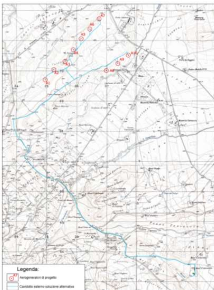
Figura 2 – layout d'impianto con soluzione alternativa per il collegamento MT (in ciano il cavidotto interno ed esterno da realizzare; in nero il tratto di cavidotto esistente di proprietà di altra società).
