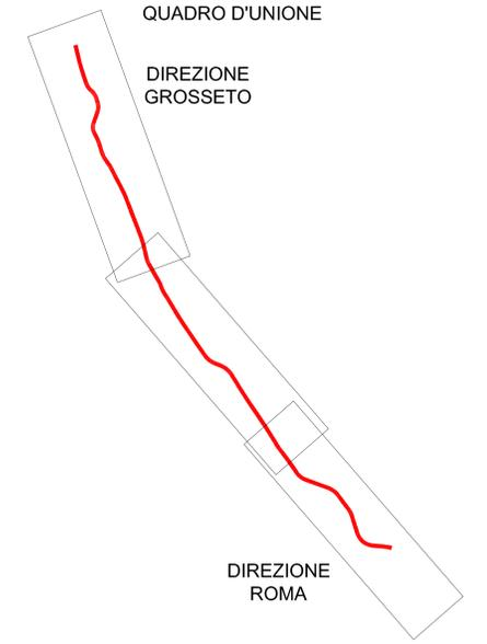
COLLETTORE ORIENTALE - deviazione planimetrica di un tratto di lunghezza pari a 700 m a monte del ponte autostradale. La sezione verrà riprofilata mediante posa in opera di krosemina; protezione 20 metri a monte e a valle dell'attraversamento mediante posa in opera di krosemina, ad esclusione del tratto in corrispondenza del ponte.
