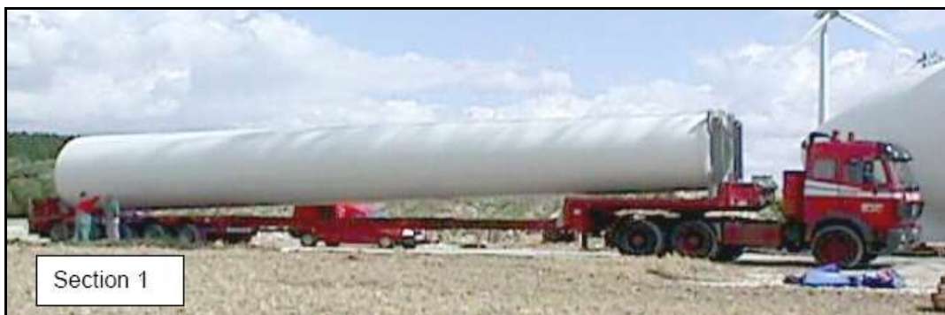
Figura 12: trasporto della sezione della torre
