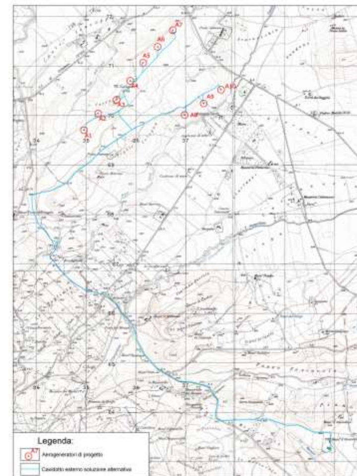
Figura 5 – layout d'impianto con soluzione alternativa per il collegamento MT (in ciano il collegamento MT)
