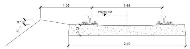
SEZIONE TIPO IN RILEVATO FERROVIARIO IN CORRISPONDENZA DEI RINVENIMENTI ARCHEOLOGICI (H > 6m) - scala 1:50 (da pk 13+690 a pk 13+740)
