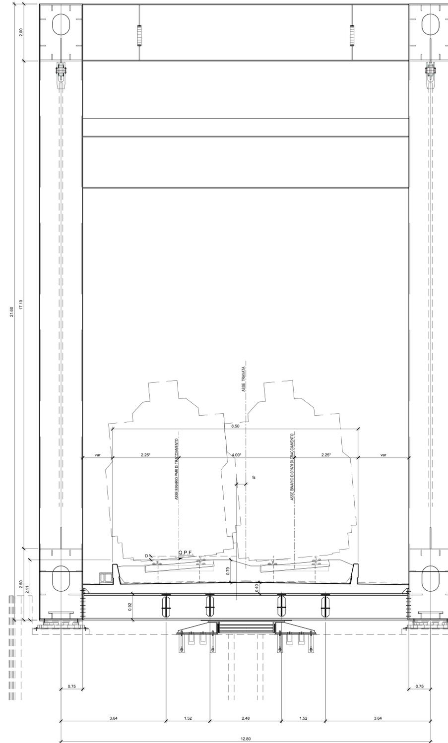
SEZIONE TIPO SU VIADOTTO VI04 (ACCIAIO 80m) IN CURVA
