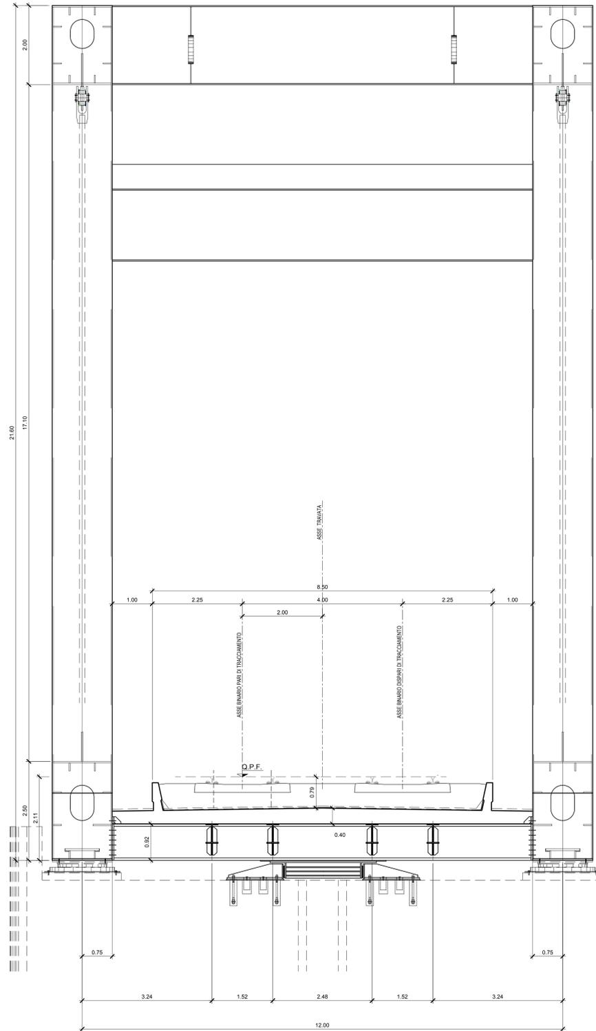
SEZIONE TIPO SU VIADOTTO VI03 (ACCIAIO 80m) IN CURVA
